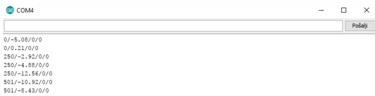
Slika 3.18. Izgled paketa podataka koji se šalje serijskim portom
