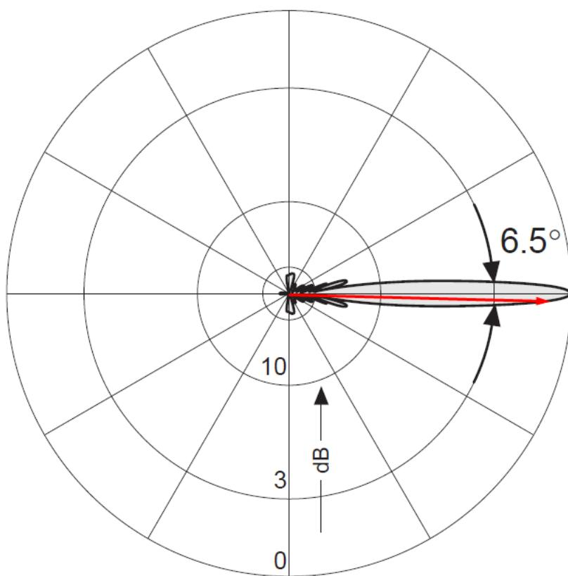
Slika 5.2 Vertikalni dijagram zračenja za antenu 730-378
