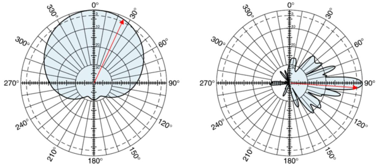
Slika 2.1 Horizontalni(ljevo) i vertikalni (desno) dijagram zračenja za antenu 742-266 [Prilog 4]
