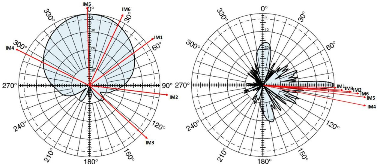
Slika 5.7 Horizontalni i vertikalni dijagrami zračenja za LTE antenu 742-266 s ucrtanim smjerovima ispitnih točaka u odnosu na smjer 1 zračenja odašiljačkih antena
