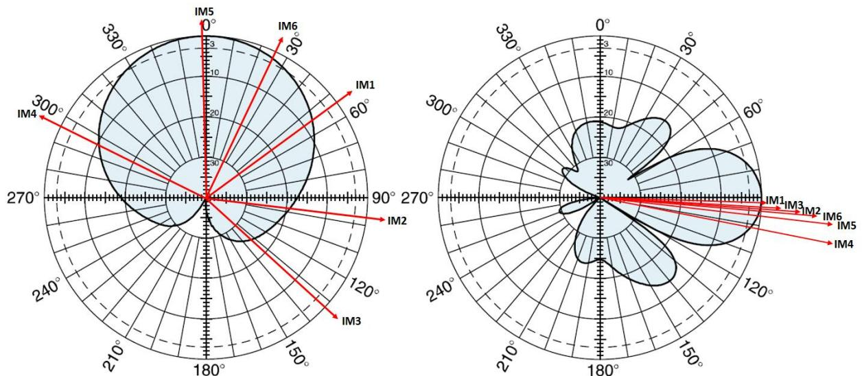
Slika 5.6 Horizontalni i vertikalni dijagram zračenja za GSM antenu 739-620 s ucrtanim smjerovima ispitnih točaka u odnosu na smjer 1 zračenja odašiljačkih antena
