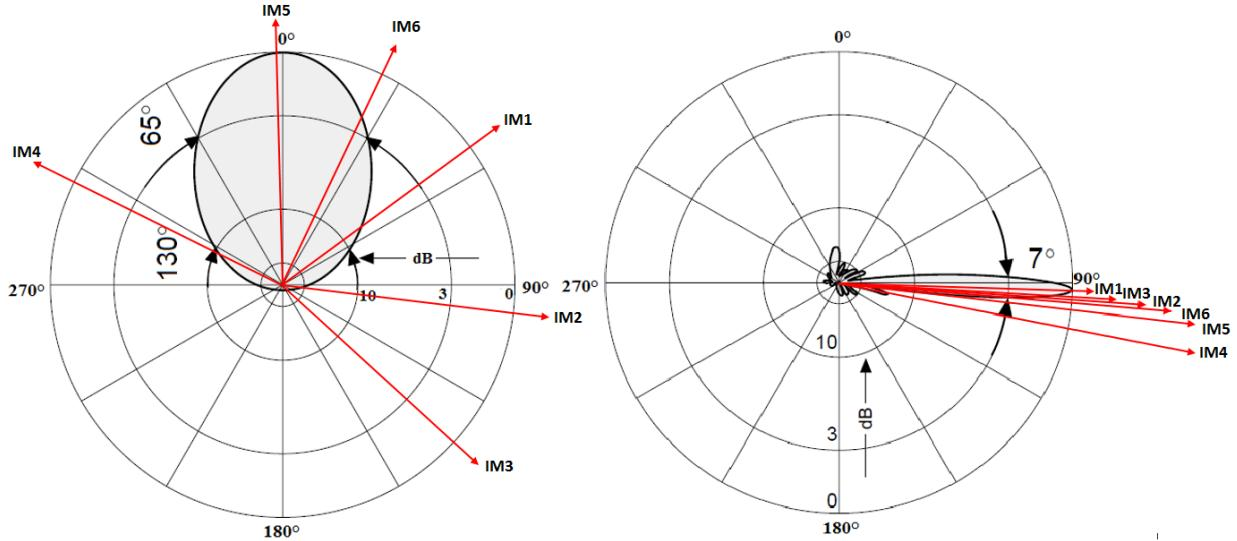
Slika 5.5 Horizontalni i vertikalni dijagram zračenja za LTE antenu 742-236 s ucrtanim smjerovima ispitnih točaka u odnosu na smjer 1 zračenja odašiljačkih antena
