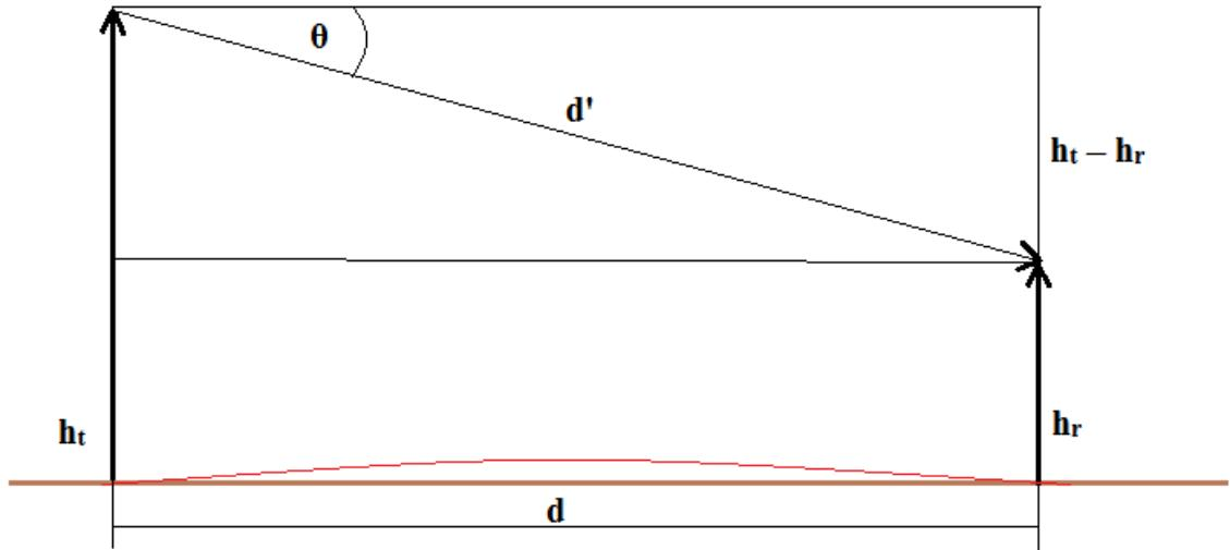
Slika 3.3 Skica izračuna korigirane udaljenosti i elevacijskog kuta
