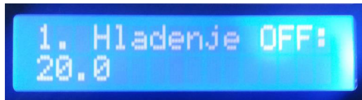
Slika 5.5. Postavljanje temperature na kojoj će se gasiti hlađenja za 1. senzor
