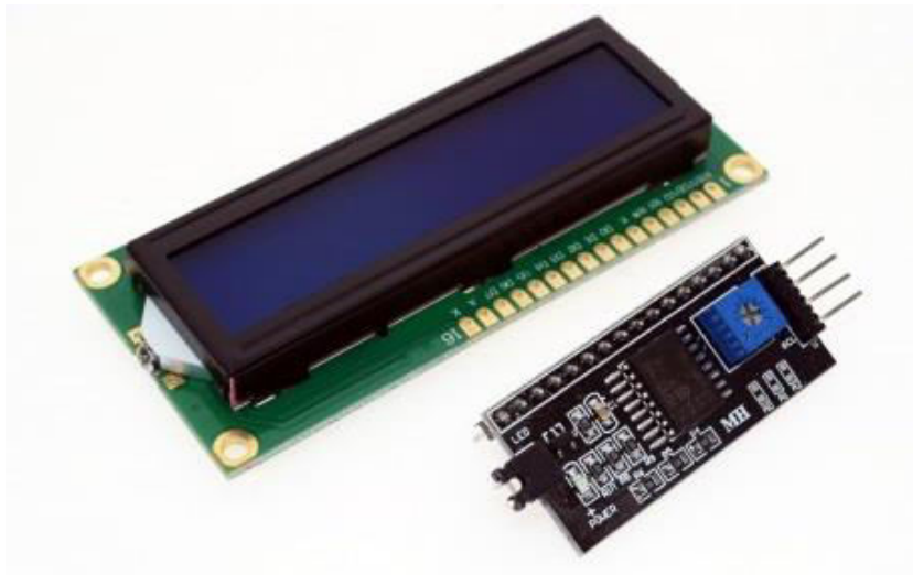
Slika 3.5. LCD 16x2 ekran sa I2C adapterom
