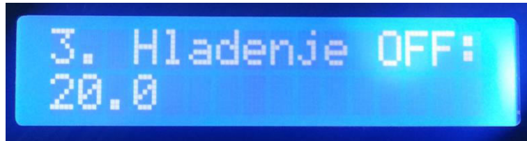
Slika 5.7. Postavljanje temperature na kojoj će se gasiti hlađenja za 3. Senzor
