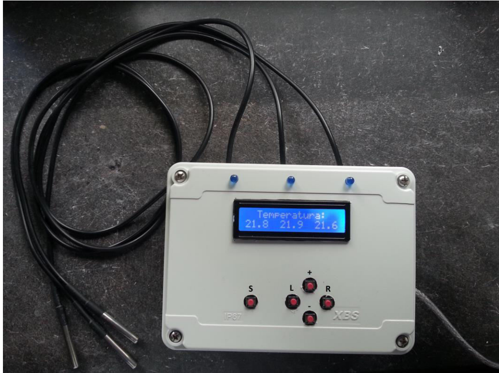
Slika 4.4. Rashladni sustav smješten u kućište
