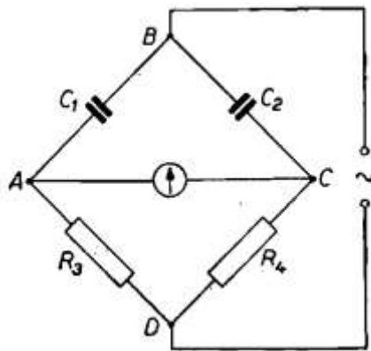
**Slika 3.3** - Principijelni spoj mosta za mjerjenje kapaciteta [7]
