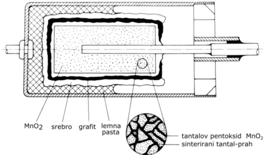
**Slika 2.4 - Presjek tantalskog elektrolitskog kondenzatora [4]**
