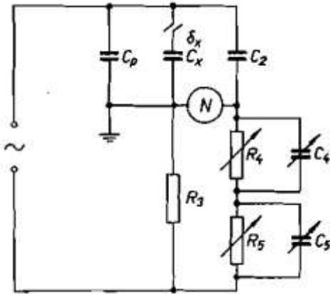
**Slika 3.10 - Varijanta Scheringova mosta za mjerjenje kondenzatora čija je jedna stezaljka uzemljena [6]**
