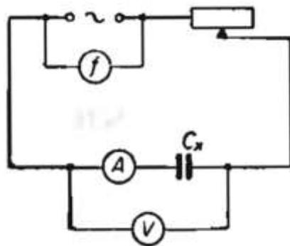
Slika 3.1. Mjerenej kapaciteta U-I metodom [7]
