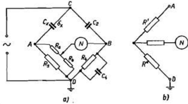
Slika 3.7 - Varijanta Scheringova mosta za mjerjenja kondenzatora velikih kapaciteta [6]
