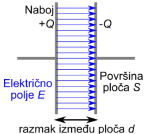
Slika 2.1 - Pločasti kondenzator [3]
