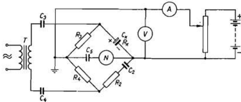
Slika 3.15 - Mjerene kapaciteta elektrolitskih kondenzatora pomoću Wienova mosta i superponiranog istosmjernog napona [6]
