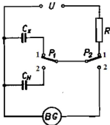
Slika 3.2 - Mjerjenje kapaciteta balističkim galvanometrom [6]
