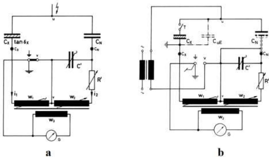
**Slika 3.14** - Transformatorski most u spoju za mjerjenje kapaciteta i kuta gubitaka a) neuzemljenog objekta b) objekta kojemu je jedna stezaljka uzemljena [5]
