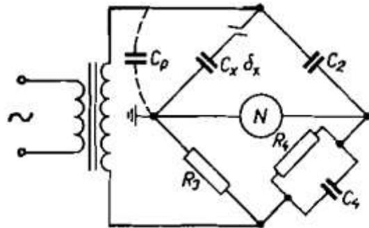
**Slika 3.9 - Mjerenje Scheringovim mostom kondenzatora čija je jedna stezaljka uzemljena [6]**
