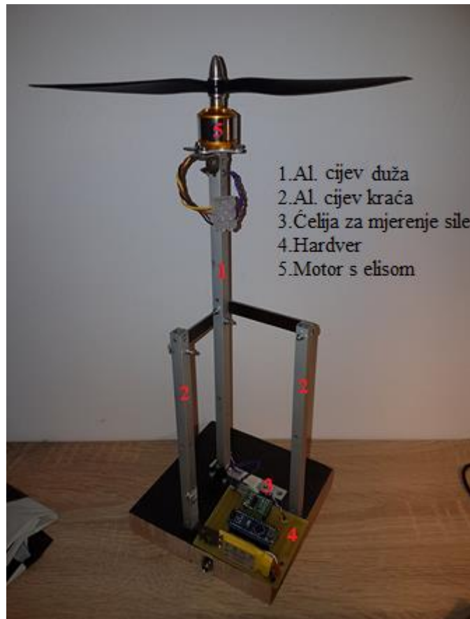
Slika 3.12. Maketa digitalne vage.
