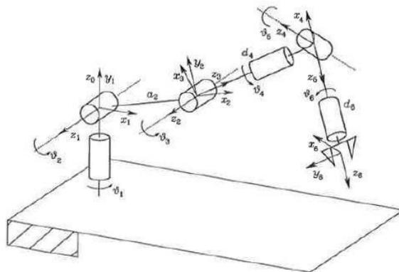
**Slika 2.2.** Cilindrična maketa robotske ruke [3]
