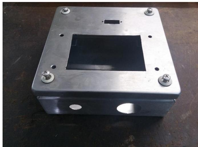
**Slika 3.4.** Aluminijsko kućište [12]
