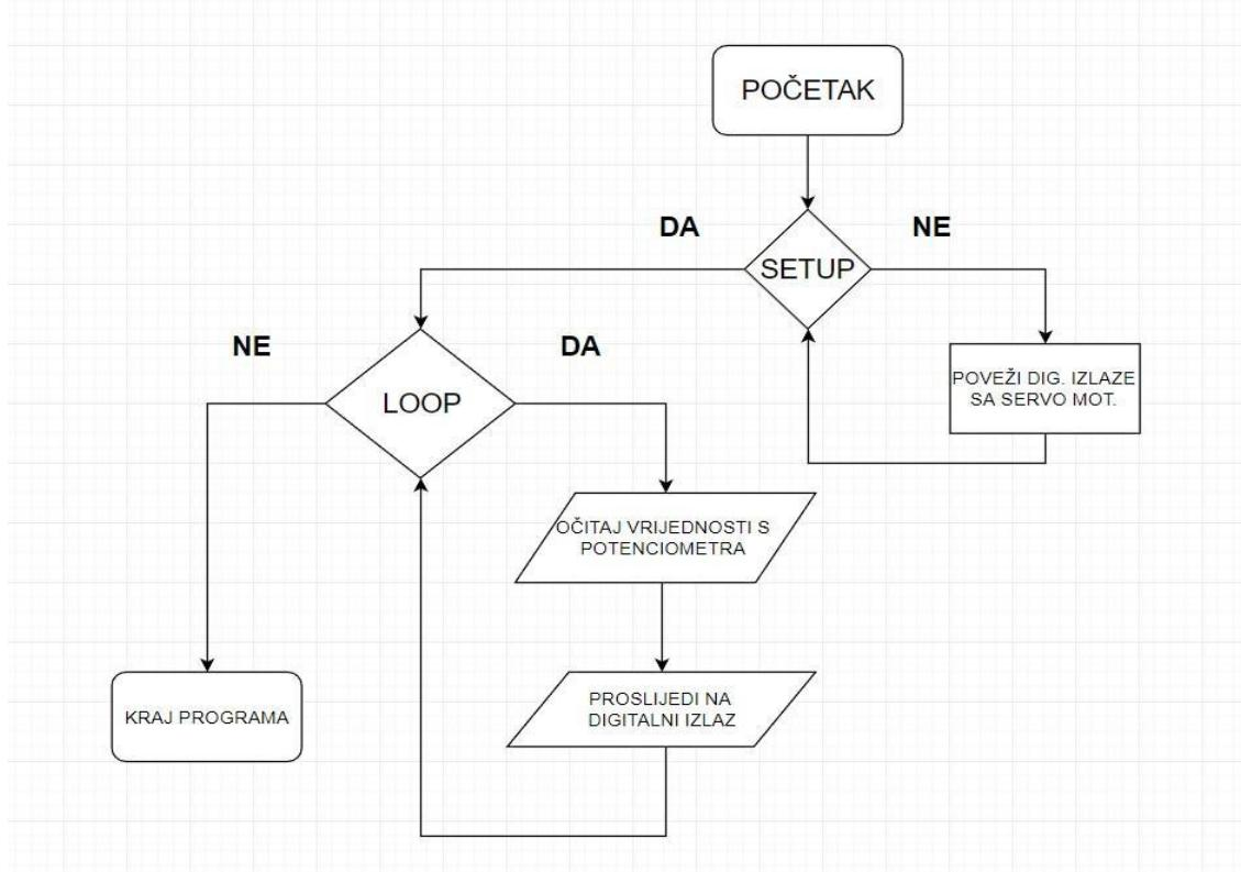
**Slika 3.17.** Blok dijagram algoritma [12]
