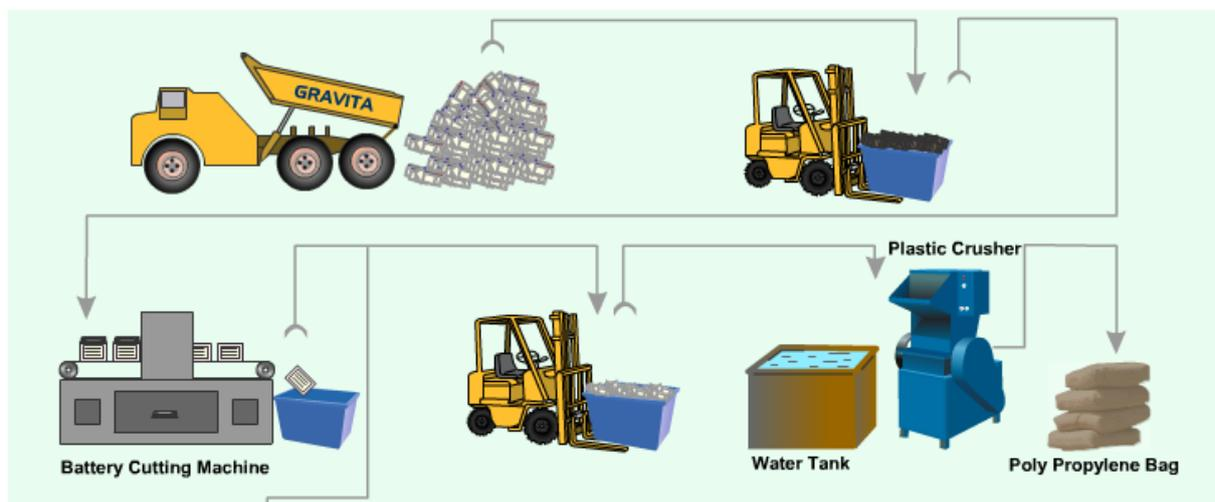
Sl.5.2.1. Shematski prikaz cjelokupnog procesa recikliranja olovno – kiselinskih akumulatora[15]
