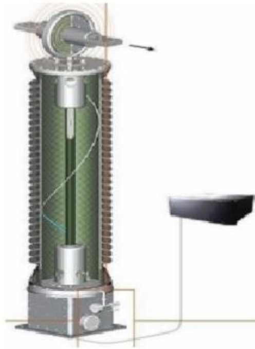
Slika 3.2.1 – Strujni mjerni transformator sa optičkim senzorom
