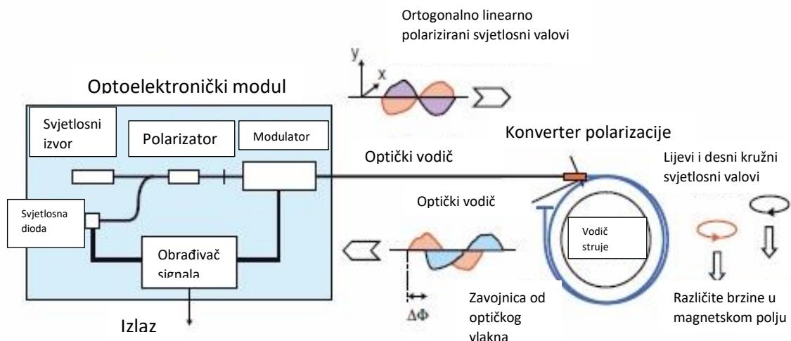
*Slika 3.5.3. – Radni princip strujnog optičkog senzora*
