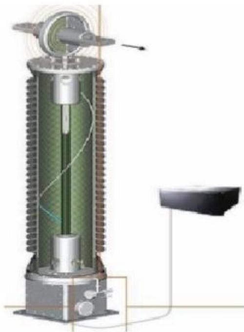
Slika 3.2.1 – Strujni mjerni transformator sa optičkim senzorom
