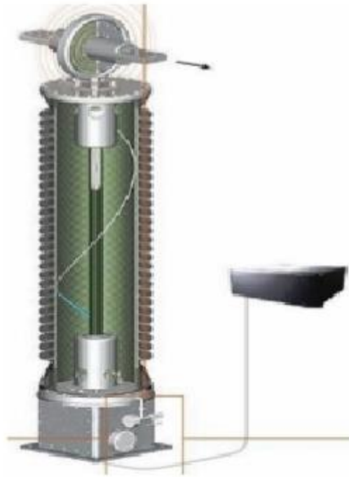
Slika 3.2.1 – Strujni mjerni transformator sa optičkim senzorom
