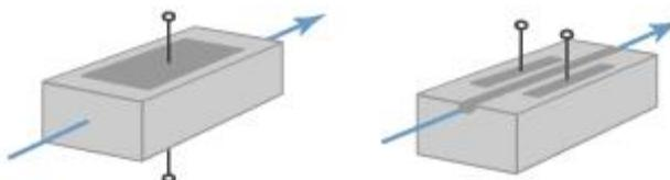
*Slika 3.2.2.2 – Pockelsove čelije s poprečnim električnim poljem*
