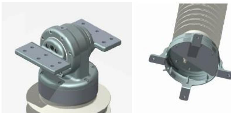
*Slika 3.5.4 – Osjetna glava i primarni terminal (lijevo), samostojeći stup i izlaz optičkog voda (desno)*
