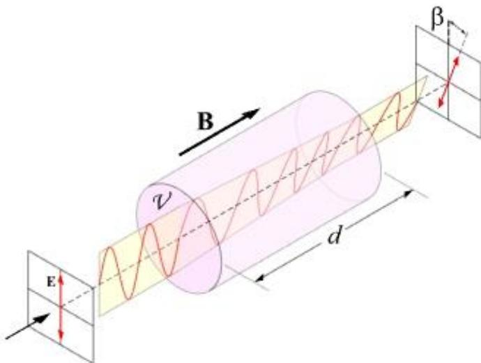
Slika 3.2.1 – Polarizacijska rotacija uslijed Faradejevog efekta
