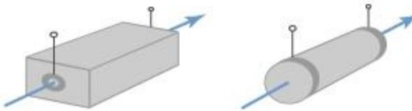
*Slika 3.2.2.1 – Pockelsove čelije s uzdužnim električnim poljem*
