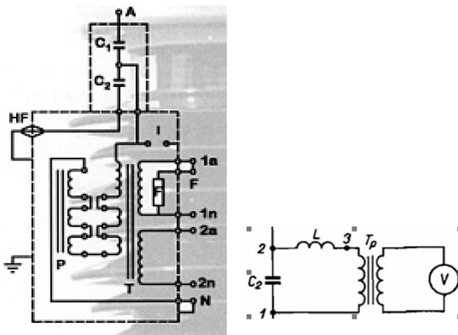
Slika 2.3.2. – Nadomjesna shema kapacitivnog naponskog transformatora
