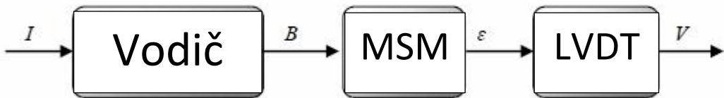
Slika 3.4.1 – Shema predloženog sistema mjerjenja struje baziranog na MSM legurama
