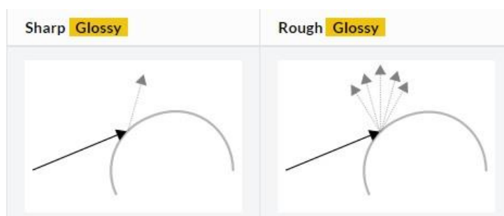
Sl. 3.25. Geometrija širenja zrake svjetlosti za sjajan Glossy efekt (lijevo) i hrapav Glossy efekt (desno)[16]
