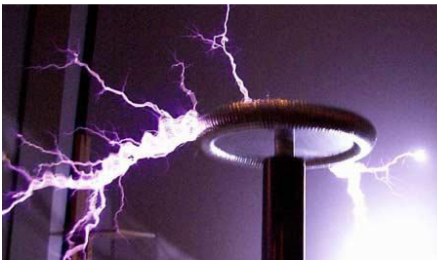
Slika 2.8. Fotografija udara munja – laboratorijski generirano pražnjenje [5].
