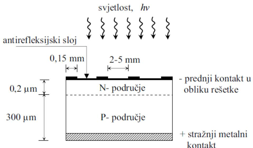
Sl 2.3. Silicijeva fotonaponska ćelija [1, str. 378].
