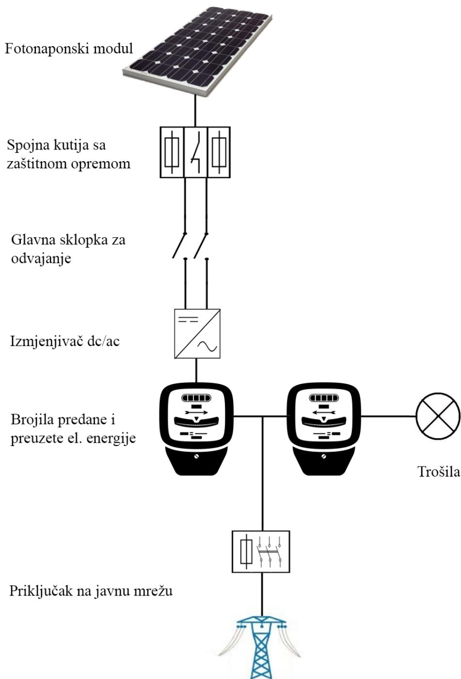
Sl. 2.2. Shema kućnog fotonaponskog sustava priključenog na javnu elektroenergetsku mrežu preko kućne instalacije.
