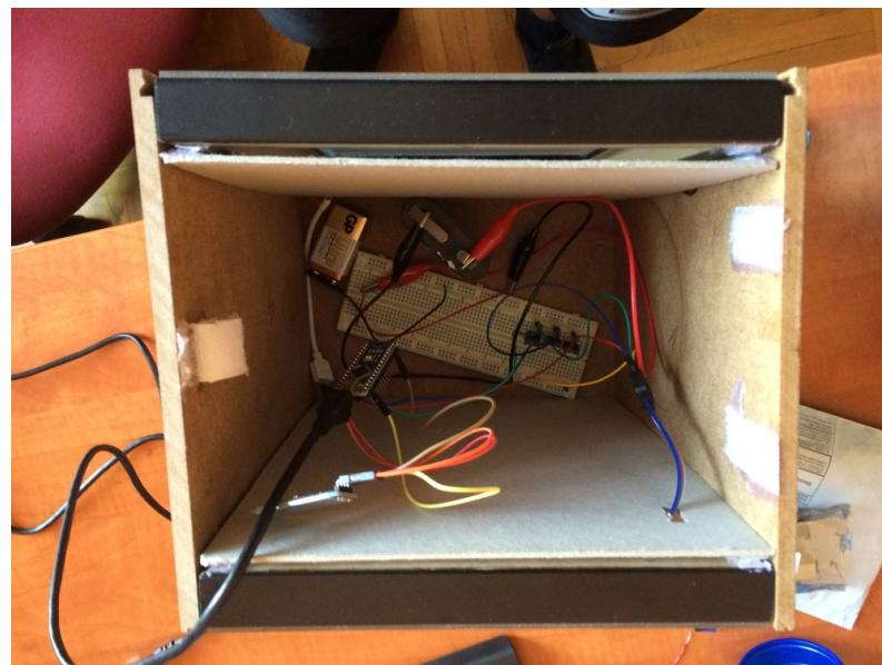
**Slika 3.10.** Spajanje LED kučišta sa Arduino razvojnim sučeljem
