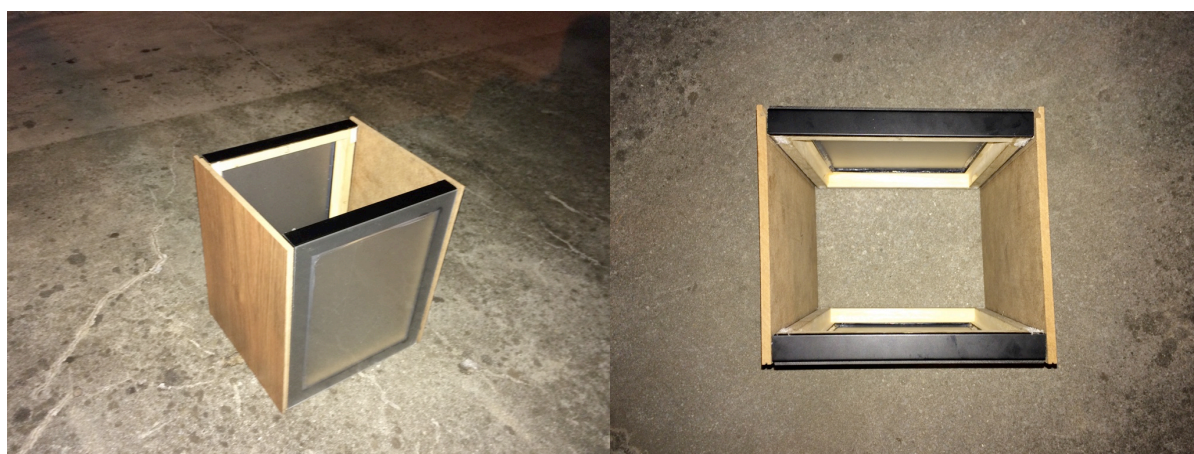
Slika 3.7. Spajanje prednjeg i stražnjeg dijela
