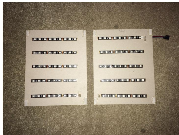
**Slika 3.5.** Ljepljenje LED rasvjete na komad kartona
