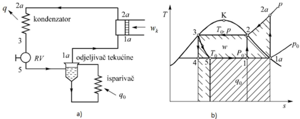
**Slika 2.5.** Shema parnog rashladnog stroja s usisavanjem suhozasićene pare (a) prikaz u T, s – dijagramu (b)
