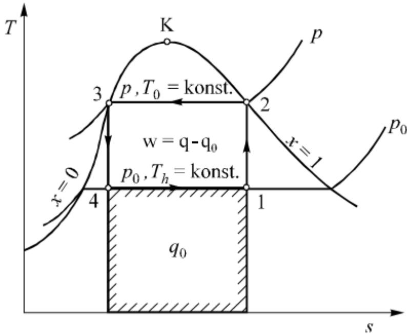
**Slika 2.3.** Kružni proces kompresorskog parnog stroja
