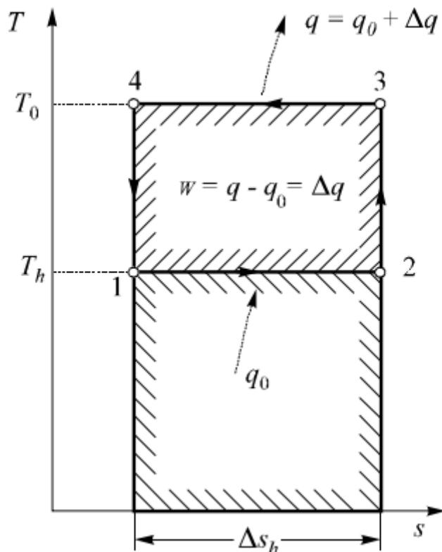
**Slika 2.1.** T,s dijagram ljevokretnog Carnotovog kružnog procesa
