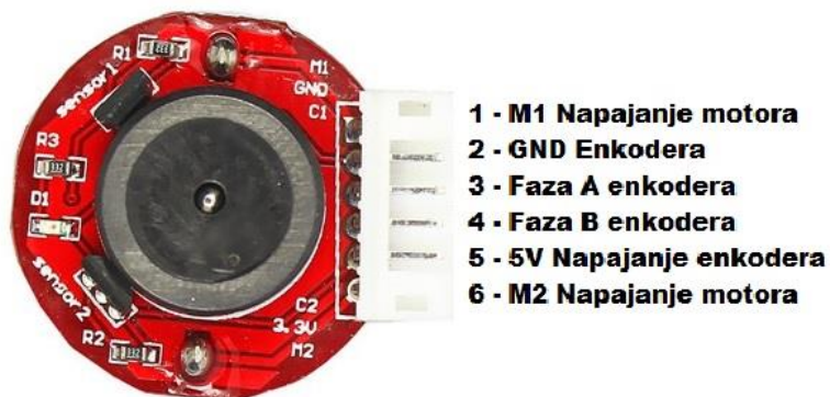
Slika 4.6. Prikaz ožičavanja motora i enkodera. [5]
