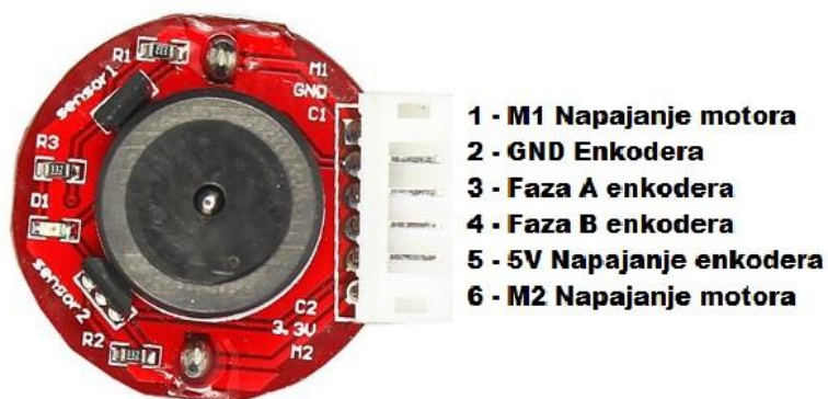
Slika 4.6. Prikaz ožičavanja motora i enkodera. [5]
