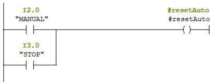
Slika 4.19. Prikaz direktne upotrebe ulaznog signala.
