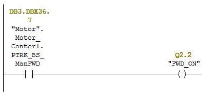
Slika 4.21. Mapiranje izlaznih digitalnih signala.
