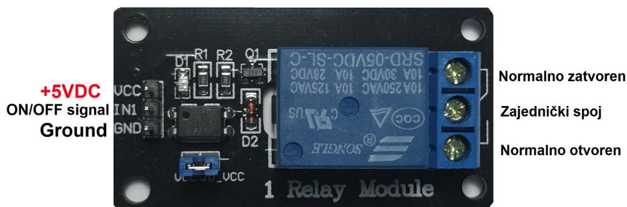
Sl. 3.12. Relejni modul sa relejnom sklopkom SRD-05VDC-SL-C
