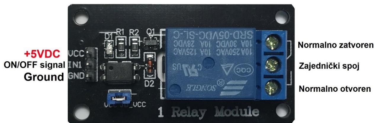
Sl. 3.12. Relejni modul sa relejnom sklopkom SRD-05VDC-SL-C
