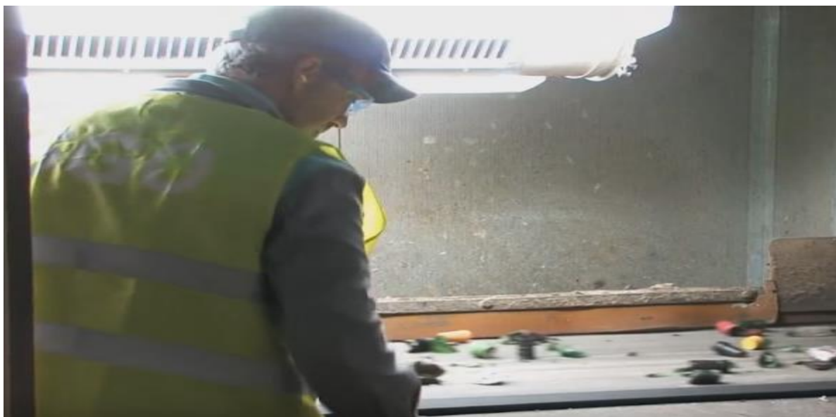
Sl. 4.1.3. Ručno odvajanje zaostalih materijala
