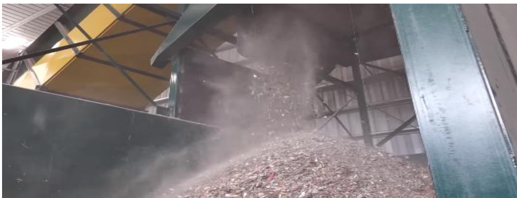
Sl. 4.2.2. Usitnjena keramika spremna za ponovnu proizvodnju
