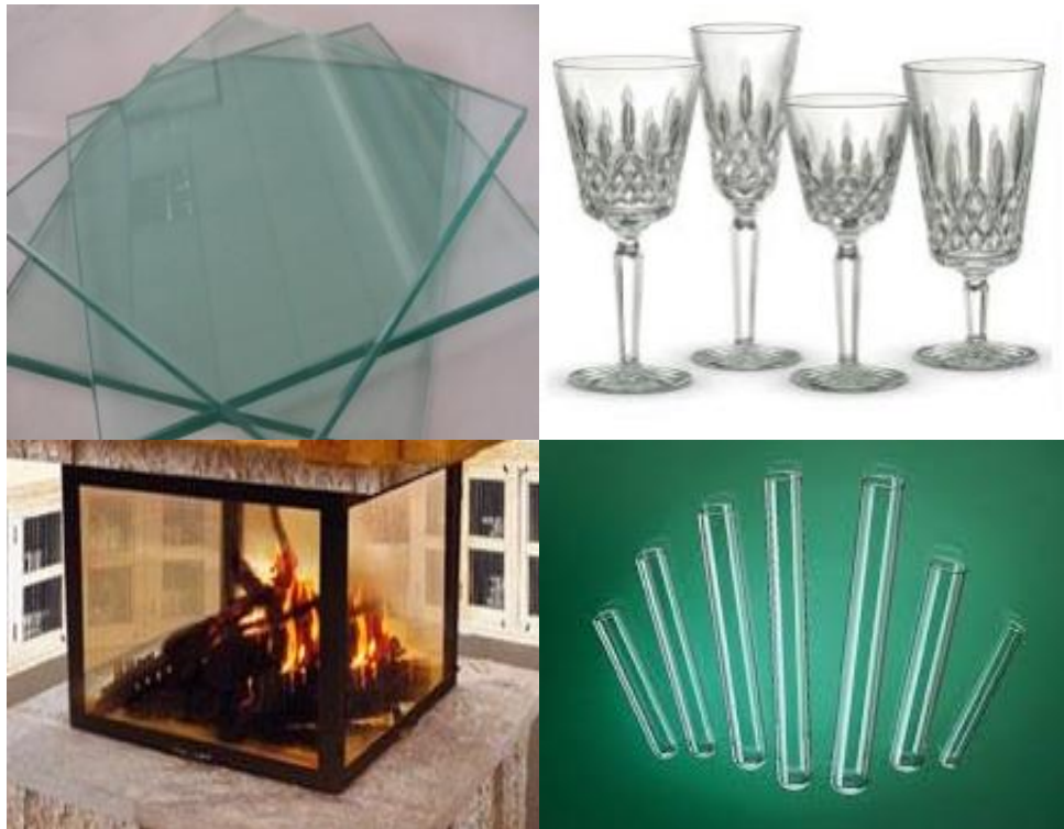
Sl. 3.1.2.1. Obično, kristalno, vatrostalno i kvarcno staklo
