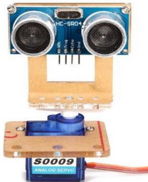
Sl. 5.1 Ultrazvučni senzor na servo motoru.[17]
