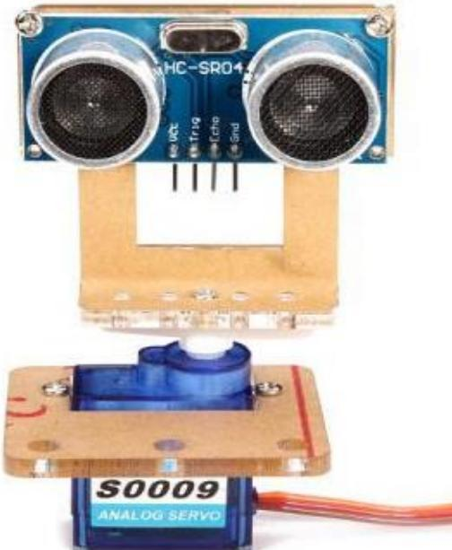
**Sl. 5.1** Ultrazvučni senzor na servo motoru.[17]
