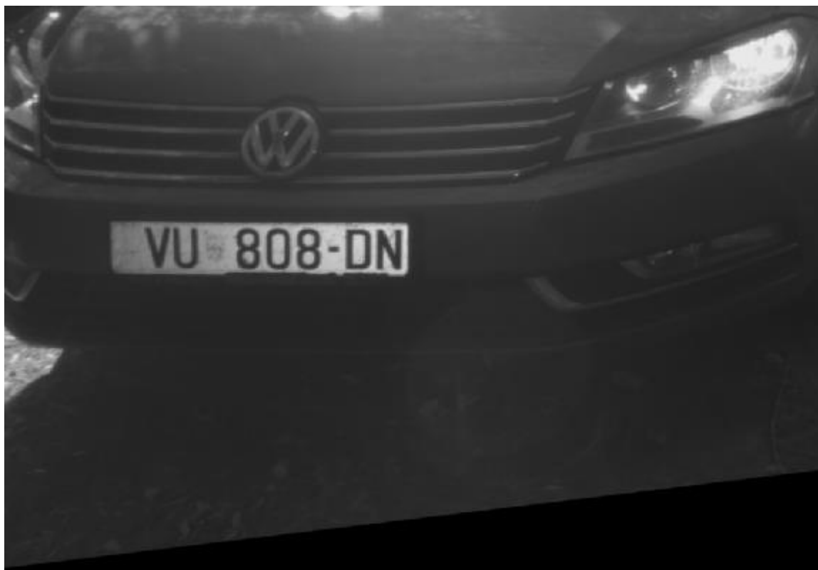
Sl. 4.11. Primjer fotografije nakon ispravljanja perspektive pomoću matrice homografije
