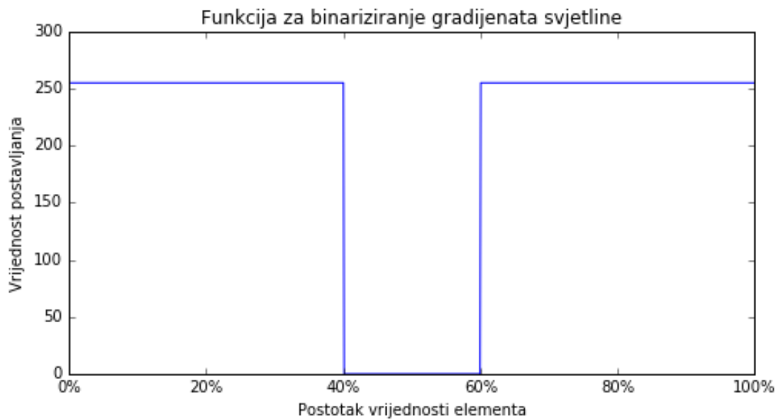
Sl. 4.3. Primjer funkcije odluke kod postupka binariziranja slike gradijenata svjetline
