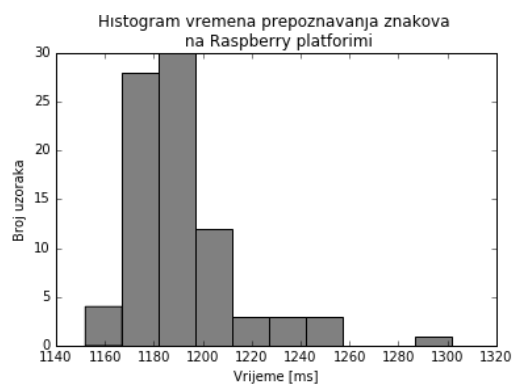
Sl. 5.6. Usporedba vremena izvođenja algoritma za potpuno prepoznavanje reg. oznake
