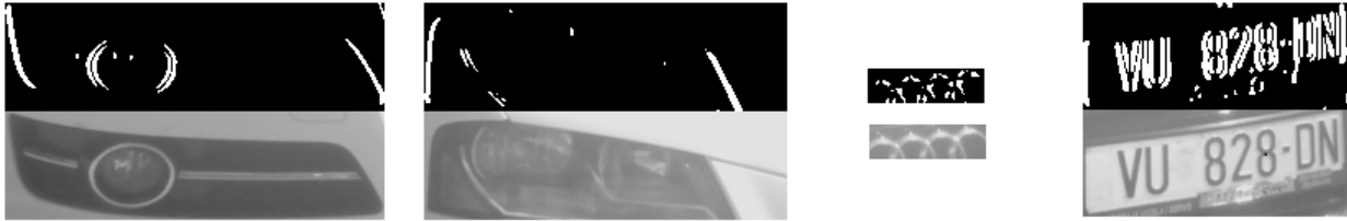
Sl. 4.7. Primjer kandidata za tablicu i njihove vrijednosti vertikalnih rubova
