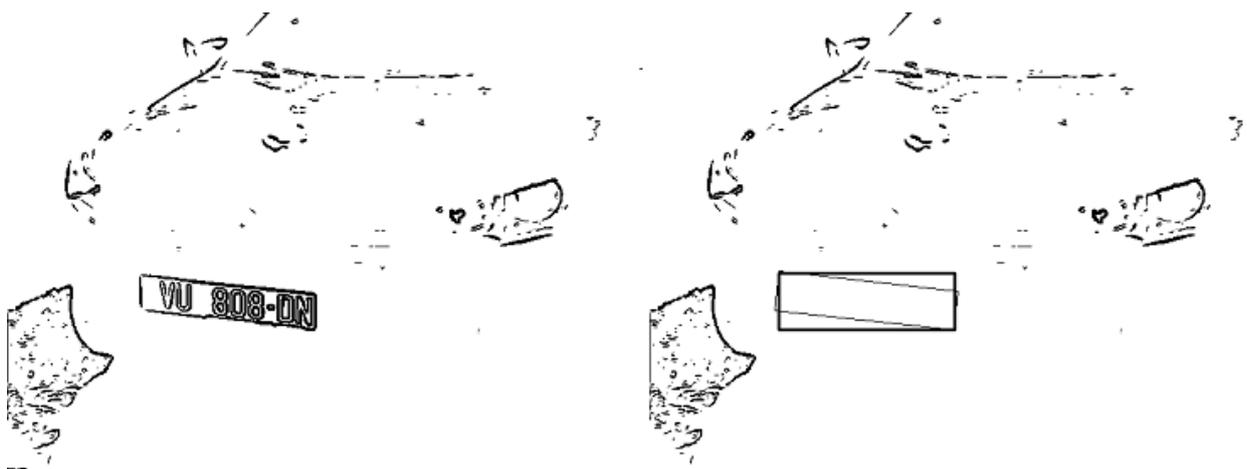
Sl. 4.6. Primjer slike rubova koja se obrađuje algoritmom za pronalazak reg. pločice (lijevo) i primjer pronađenih kontura koje opisuju registracijsku pločicu (desno)
