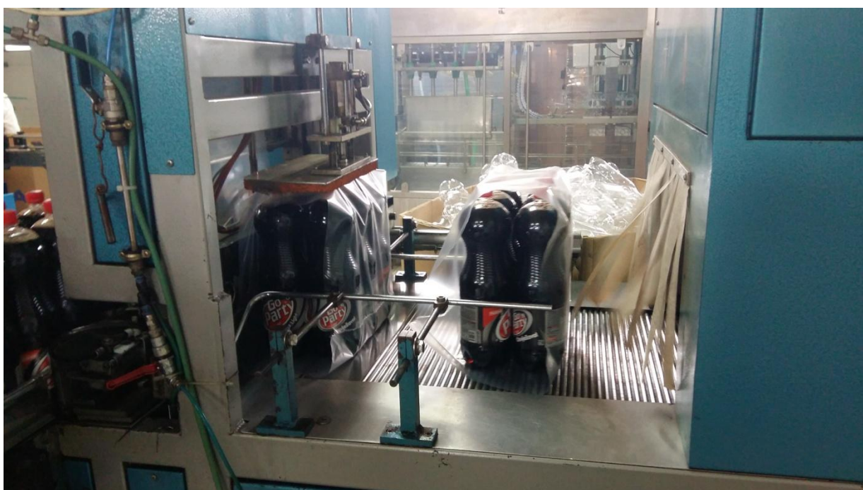
Slika 3.26. Ulaz u termotunel
