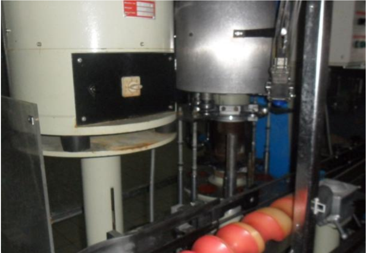
Slika 3.21. Stroj za zatvaranje boca – Zatvaračica 2
