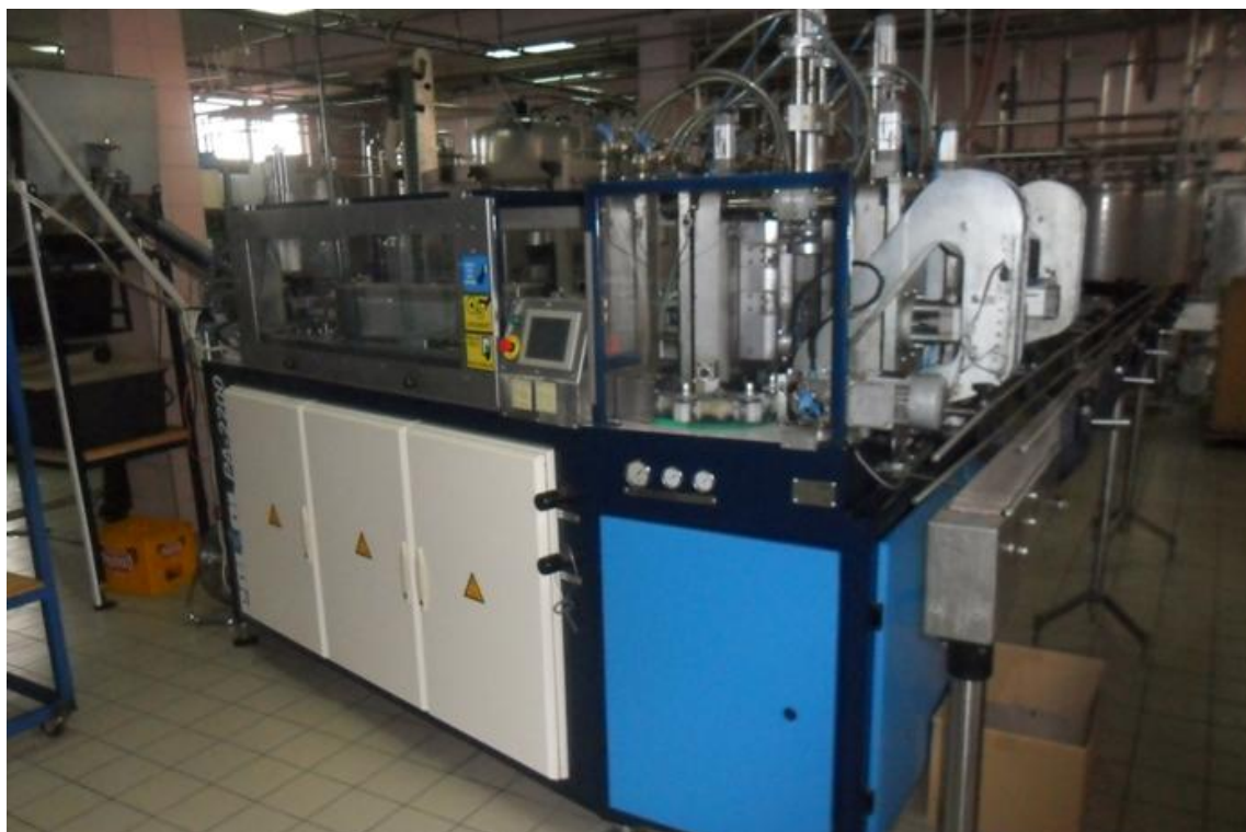
Slika 3.11. Stroj za pravljenje boca –Puhalice
