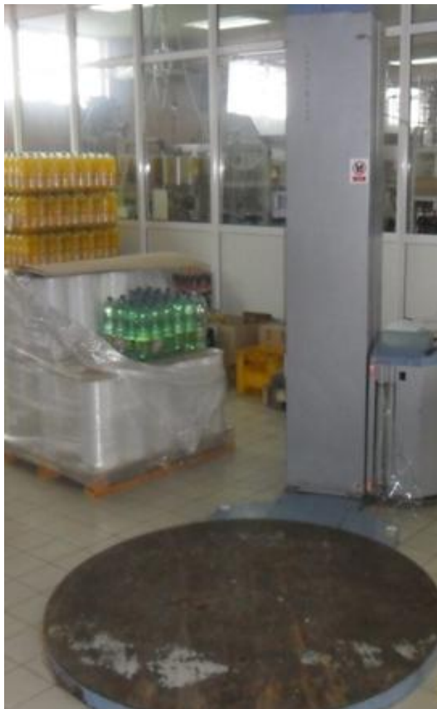
Slika 3.29. Stroj za omatanje paleta s okretnim postoljem
