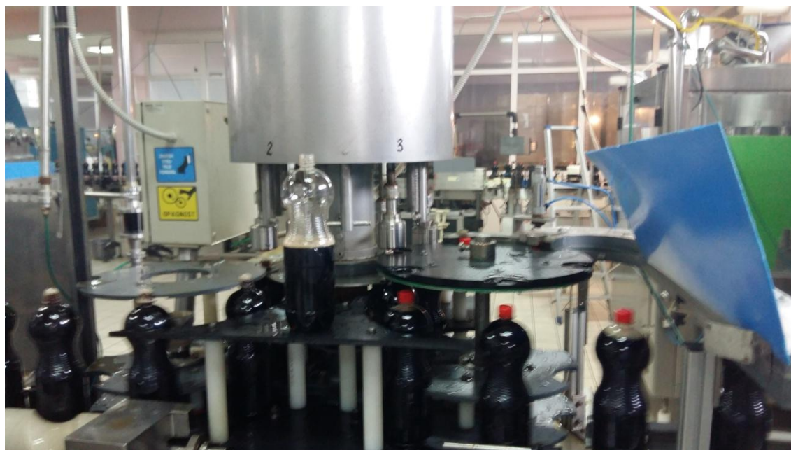
Slika 3.19. Stroj za zatvaranje boca
