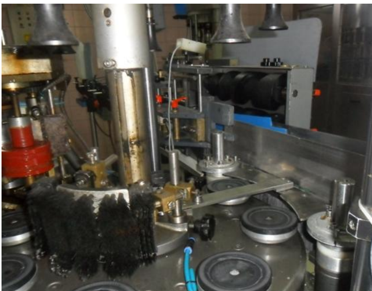
Slika 3.22. Stroj za etiketiranje boca - Etiketirka br.1
