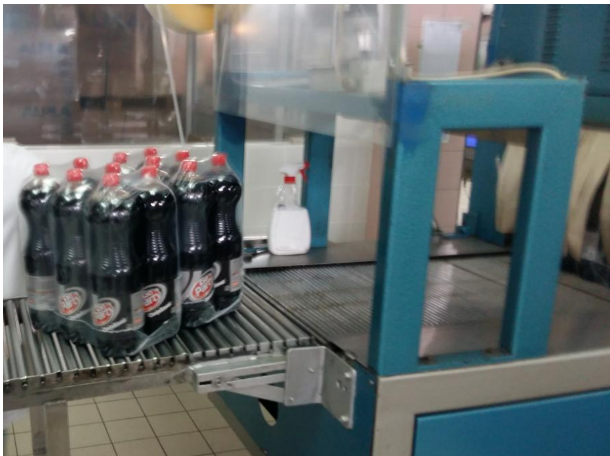
Slika 3.27. Kraj termotunela- dio gdje izlaze gotovi paketi
