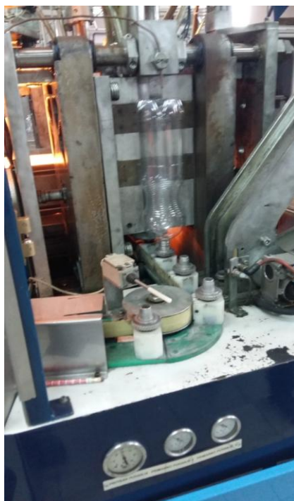
Slika 3.13. Kalup i gotovi proizvod ( PET boca)
