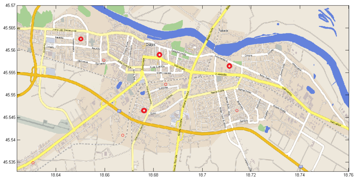
Slika 6.9 Razvrstavanje objekata na devet grozdova u slučaju povećanog opterećenja u blizini gradskih tržnica
