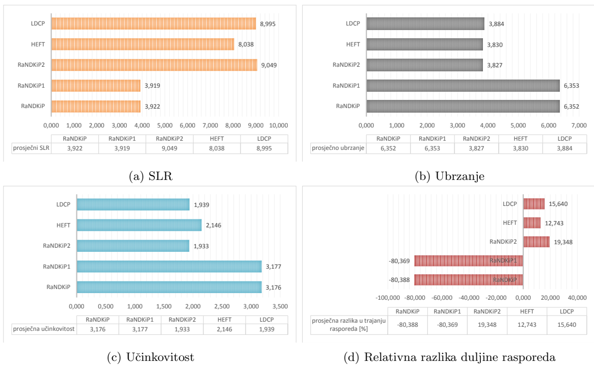
Slika 5.48: Skupne vremenske performanse raspoređivanja programa na računalne platforme s raznorodnim komunikacijskim vezama.
