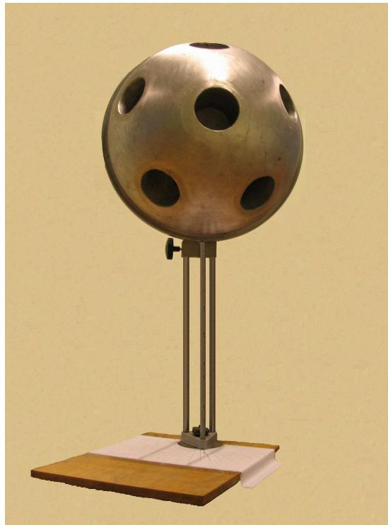
**Slika 8.3.** Sfernni eksperimentalni model kojeg predstavljaju šest valovoda (radijus valovoda  $r_w=6\text{cm}$ ) na sferi radijusa  $r_s=30\text{cm}$  ( $\alpha_1=0^\circ, \beta_{11}=0^\circ; \alpha_2=56^\circ, \beta_{21}=36^\circ, \beta_{22}=108^\circ, \beta_{23}=180^\circ, \beta_{24}=252^\circ$  i  $\beta_{25}=324^\circ$ ) [57].
