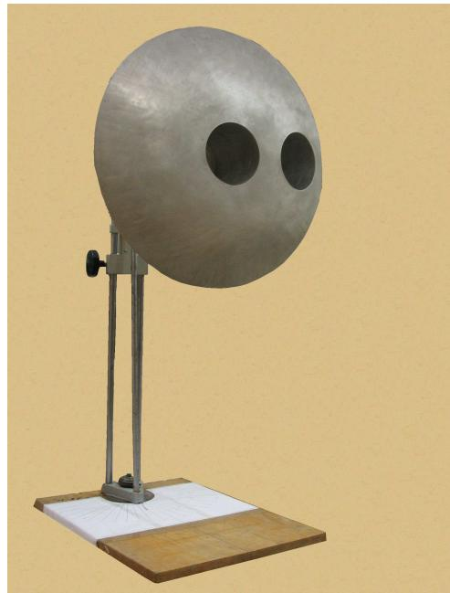
**Slika 8.1.** Sferni eksperimentalni model predstavljen s dva valovoda (radijus valovoda  $r_w=6\text{cm}$ ) na sferi radijusa  $r_s=69\text{cm}$  ( $\alpha_1=0^\circ$ ,  $\beta_{11}=0^\circ$ ;  $\alpha_2=18^\circ$ ,  $\beta_{21}=90^\circ$ ) [57].
