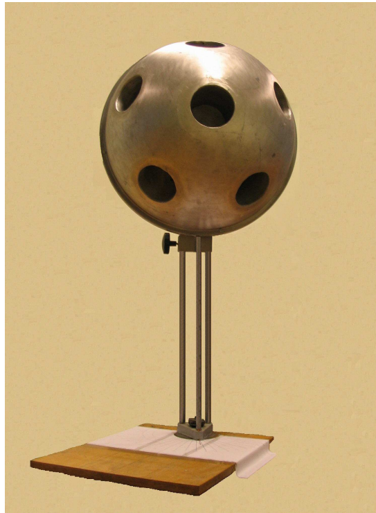
Slika 8.3. Sforni eksperimentalni model kojeg predstavljaju šest valovoda (radijus valovoda r_w=6\text{cm} ) na sferi radijusa r_s=30\text{cm} ( \alpha_1=0^\circ, \beta_{11}=0^\circ; \alpha_2=56^\circ, \beta_{21}=36^\circ, \beta_{22}=108^\circ, \beta_{23}=180^\circ, \beta_{24}=252^\circ i \beta_{25}=324^\circ ) [57].
