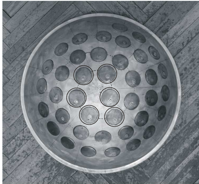
Slika 8.22. Aktivne mikrotrakaste antene sfernog niza spiralnog rasporeda na sferi radijusa 30 cm ( \alpha_1=8,11^\circ , \beta_1=49,94^\circ ; \alpha_2=11,48^\circ , \beta_2=153,07^\circ ; \alpha_3=14,07^\circ , \beta_3=226,18^\circ ; \alpha_4=16,26^\circ , \beta_4=286,03^\circ ; \alpha_5=18,19^\circ , \beta_5=337,99^\circ ; \alpha_6=19,95^\circ , \beta_6=24,58^\circ ).
