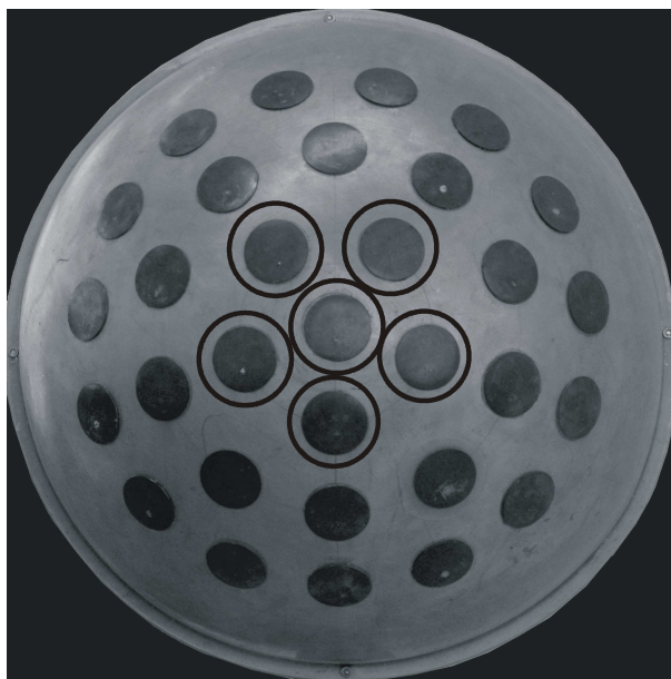
Slika 8.18. Aktivne mikrotrakaste antene sfernog niza ikosaedarskog rasporeda na sferi radijusa 30 cm ( \alpha_1=0^\circ , \beta_{11}=0^\circ , \alpha_2=15^\circ , \beta_{21}=0^\circ , \beta_{22}=72^\circ , \beta_{23}=144^\circ , \beta_{24}=216^\circ , \beta_{25}=288^\circ ).
