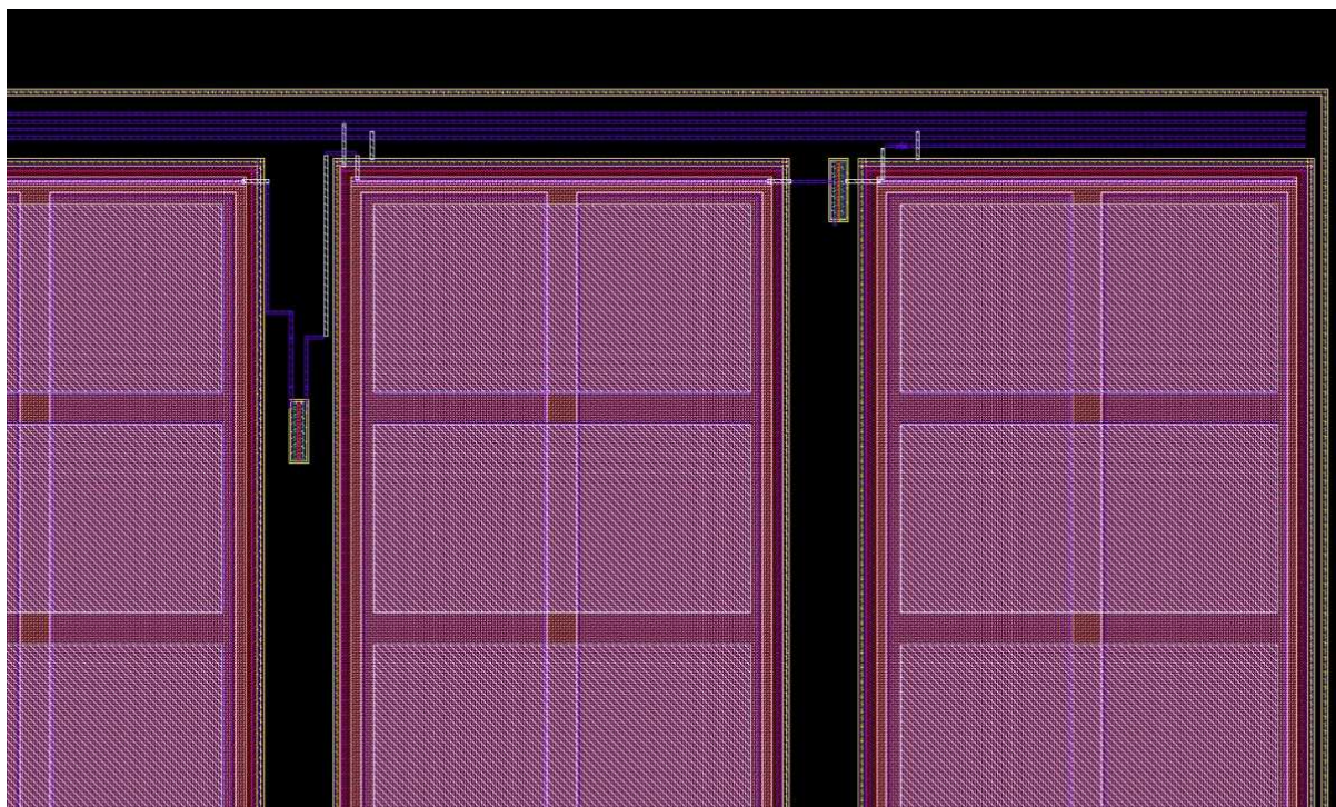
Slika 6.19. Topološki nacrt Dicksonove nabojske pumpe – uvećani prikaz
