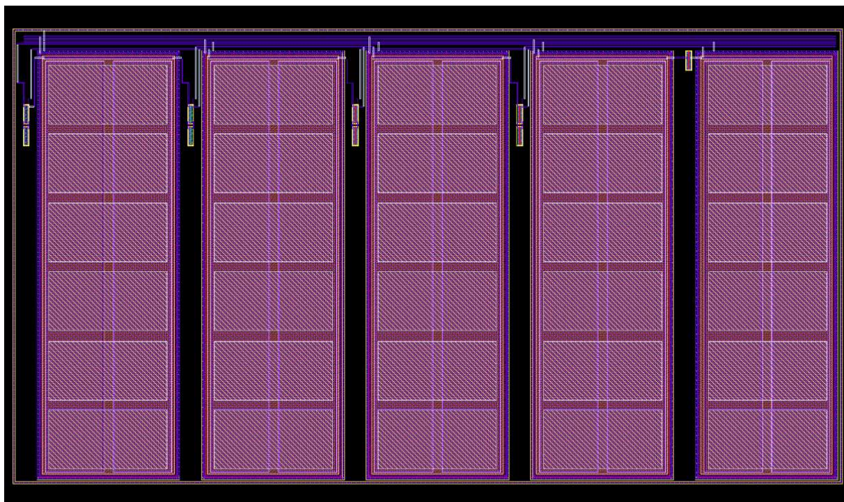
Slika 6.20. Topološki nacrt CTS nabojske pumpe
