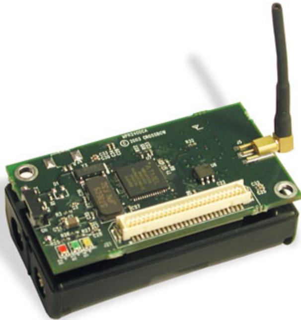
**Slika 2.2 Primjer bežičnog senzorskog čvora (Crossbow MICAz 2.4 GHz)**
