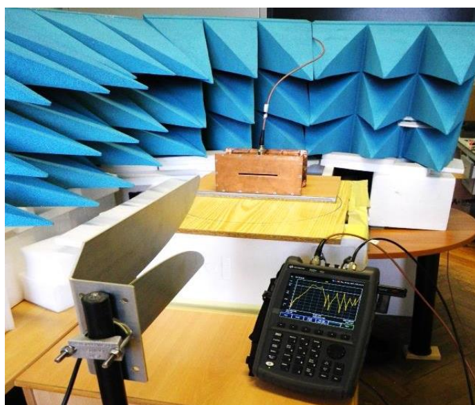
Slika 3.3. Mjerna oprema i metalno kućište Model IV „Lilchi“ (200x100x100mm) s prorez otvorom dimenzija 100x5 mm [10]
