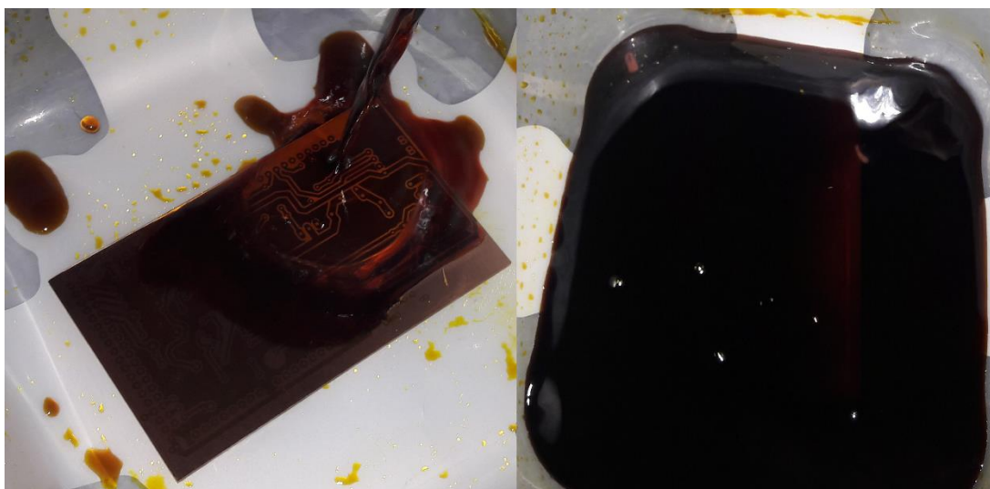
Sl. 3.23. Jetkanje tiskane pločice
