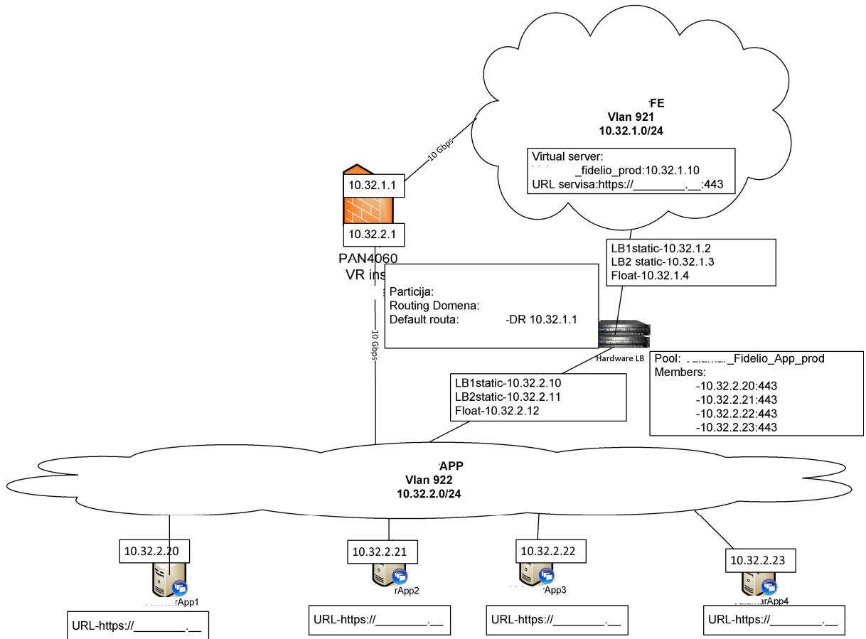
Slika 5.16 Struktura sustava s load balancerima
