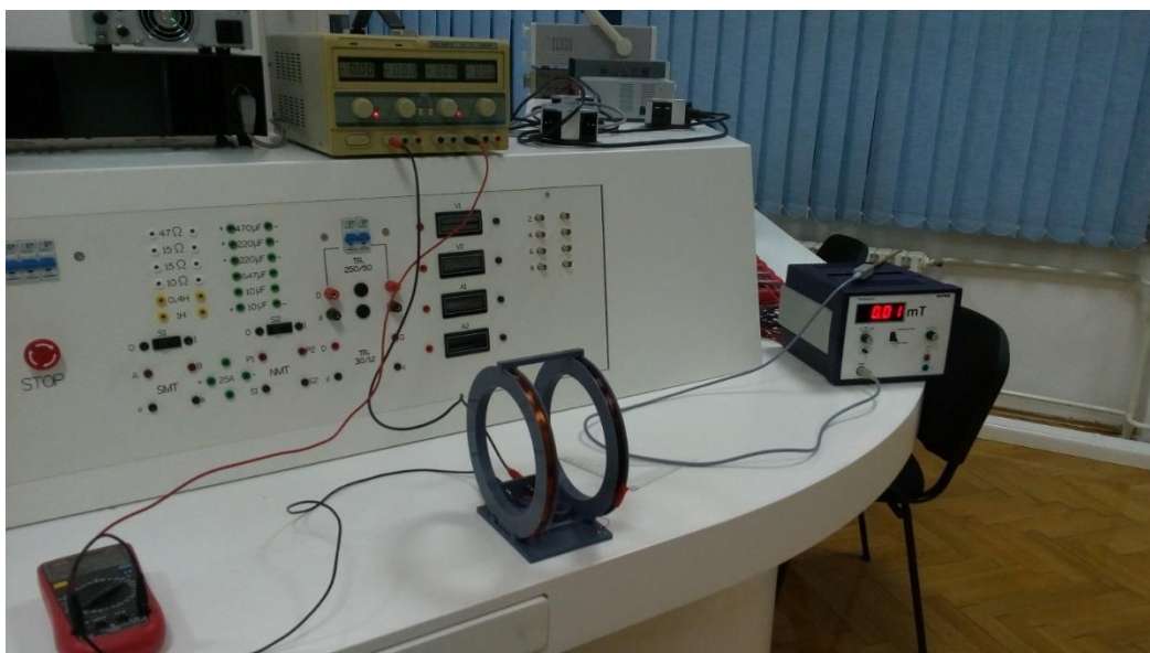
Slika 5.13. Fotografija mjernog uređenja za mjerenje magnetskog polja unutar Helmholtzovog svitka
