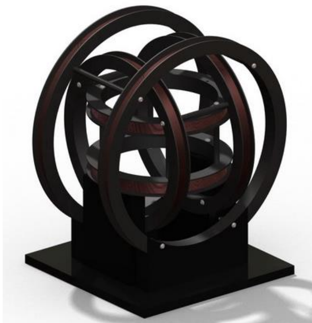
Slika 3.3. Helmholtzov sustav svitaka sa tri para svitaka [13]
