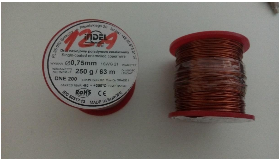
Slika 5.6. Bakrena žica korištena pri konstrukciji zavojnica
