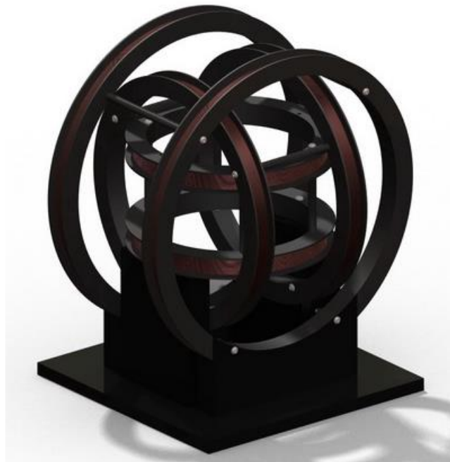
Slika 3.3. Helmholtzov sustav svitaka sa tri para svitaka [13]
