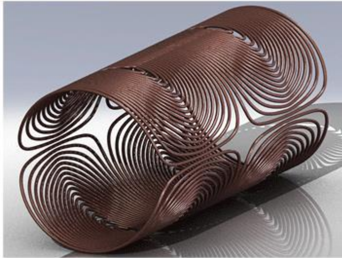
Slika 4.4. Izvedba Golay svitka kao zavojnice u obliku otiska prsta[19]
