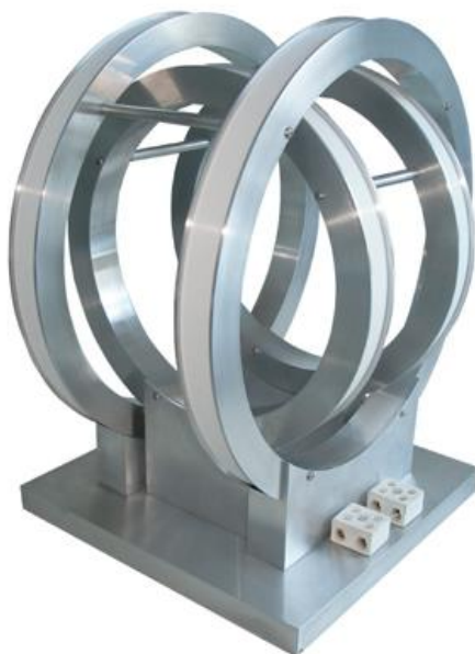
Slika 3.2. Helmholtzov sustav svitaka sa dva para svitaka [12]
