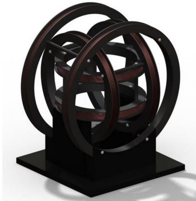
Slika 3.3. Helmholtzov sustav svitaka sa tri para svitaka [13]
