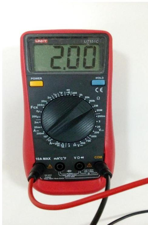
*Slika 5.12.* Multimetar UNI-T, UT151C
