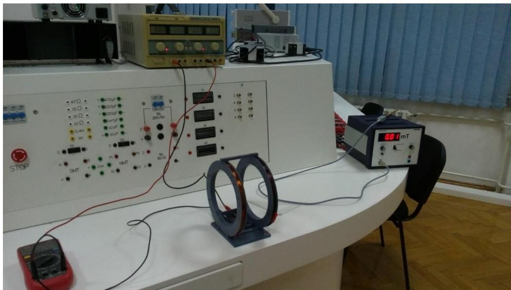
*Slika 5.13.* Fotografija mjernog uređenja za mjerjenje magnetskog polja unutar Helmholtzovog svitka
