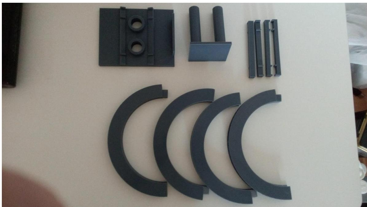
*Slika 5.5.* Isprintani i očišćeni dijelovi zavojnica
