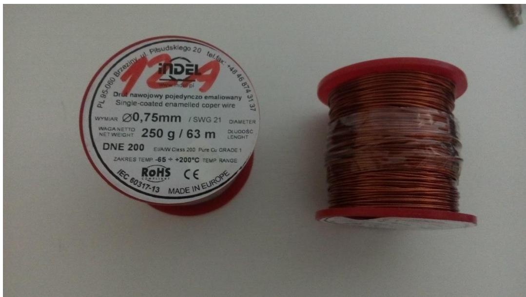
*Slika 5.6.* Bakrena žica korištena pri konstrukciji zavojnica
