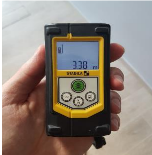
Slika 3.1. Laserski daljinomjer Stabila – LD 320 ispar
