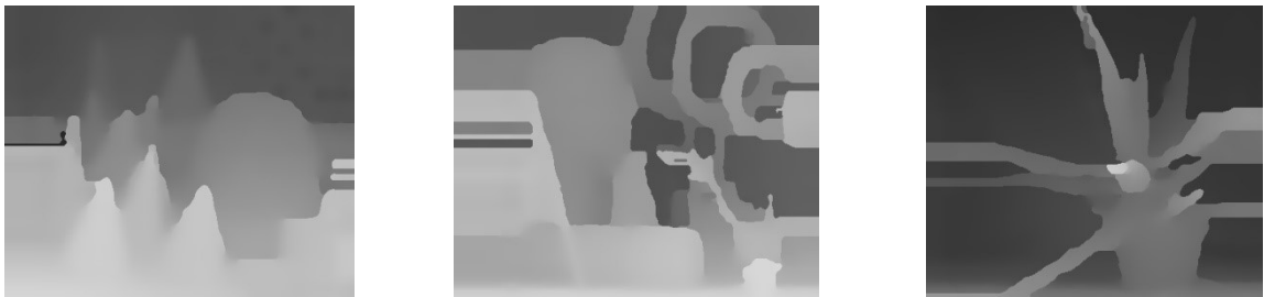
Slika 5.6. Primjeri slike dispariteta za algoritam mc-cnn KITTI slow
