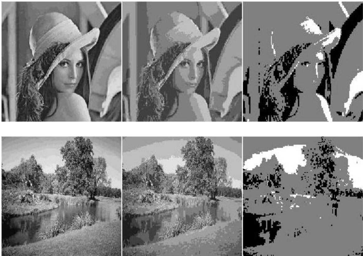
Sl.3.3: Prvi red, s lijeva na desno: Prva razina dekompozicije DWT kompresija za različite korake kvantizacije. Dekodirane slike lena: a) k = 25 b) k = 80 c) k = 260 . Drugi red, s lijeva na desno: Prva razina dekompozicije DWT kompresija za različite korake kvantizacije. Dekodirane slike priroda: d) k = 25 e) k = 80 f) k = 260 .
