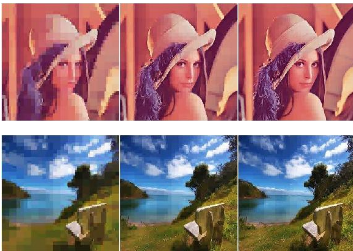
Sl.3.7: Prvi red s lijeva na desno: lena a) 1% b) 5% c) 10% očuvanih wavelet koeficijenata slike upotrebom Wavelet kompresije. Drugi red s lijeva na desno: priroda d) 1% e) 5% f) 10 % očuvanih wavelet koeficijenata slike upotrebom Wavelet kompresije.
