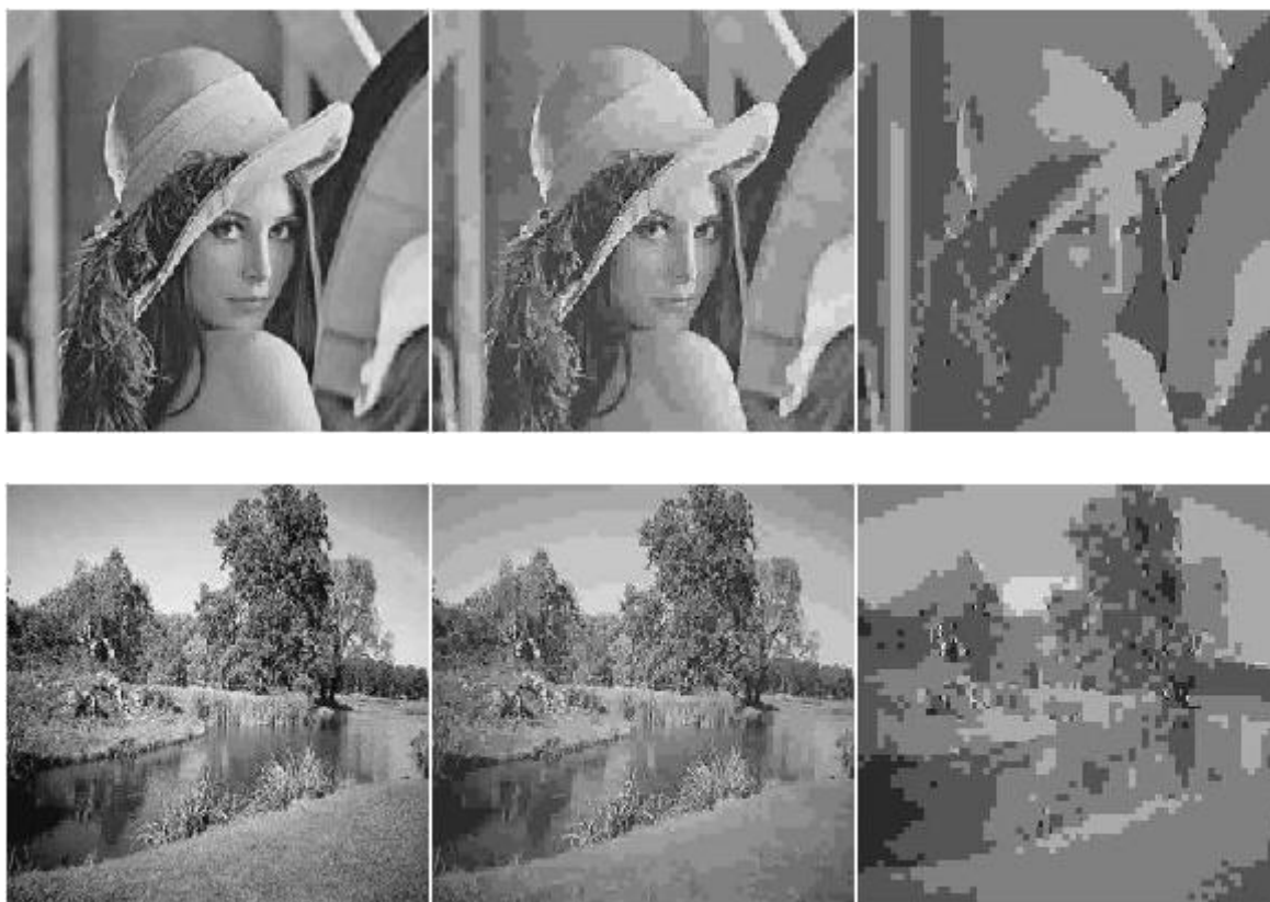
Sl.3.4: Prvi red, s lijeva na desno: Druga razina dekompozicije DWT kompresija za različite korake kvantizacije. Dekodirane slike lena: a) k = 25 b) k = 80 c) k = 260 . Drugi red, s lijeva na desno: Druga razina dekompozicije DWT kompresija za različite korake kvantizacije. Dekodirane slike priroda: d) k = 25 e) k = 80 f) k = 260 .
