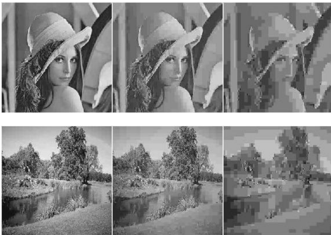
SI.3.5: Prvi red, s lijeva na desno: Treća razina dekompozicije DWT kompresija za različite korake kvantizacije. Dekodirane slike lena: a) k = 25 b) k = 80 c) k = 260 . Drugi red, s lijevo na desno: Treća razina dekompozicije DWT kompresija za različite korake kvantizacije. Dekodirane slike priroda: d) k = 25 e) k = 80 f) k = 260 .
