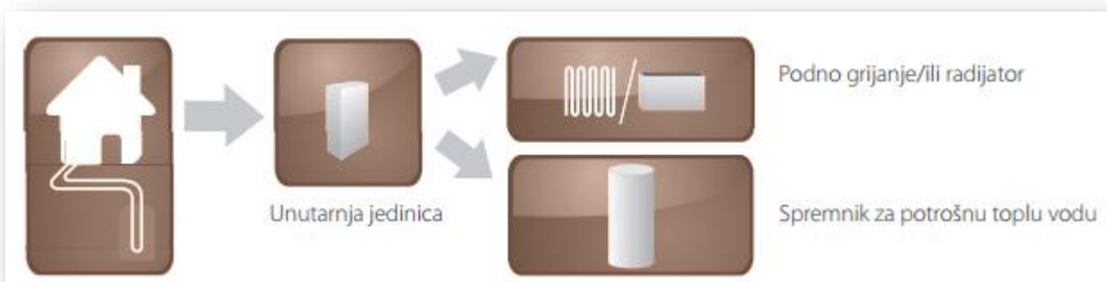
Slika 2.8 Shema rada geotermalne dizalice topline tlo-voda, [2].
