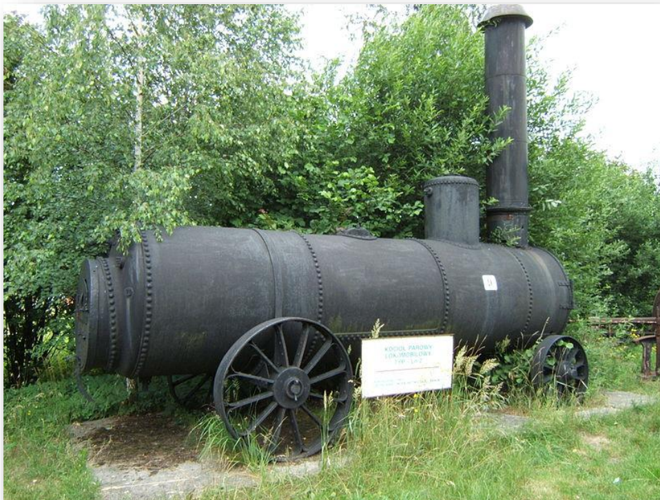
Slika 2.1 Izgled cilindričnog (Cornwallskog) kotla u uporabi na vlaku, [6].
