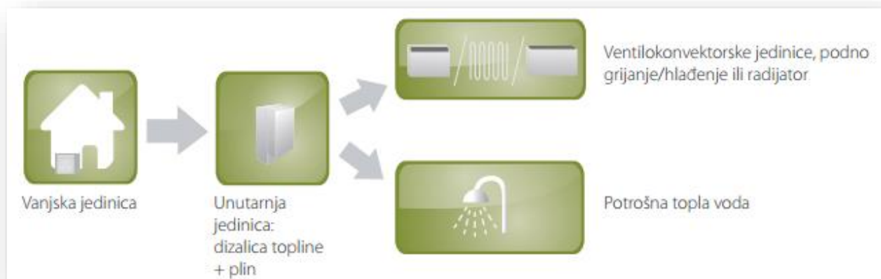
Slika 2.9 Shema rada hibridne dizalice topline, [2].
