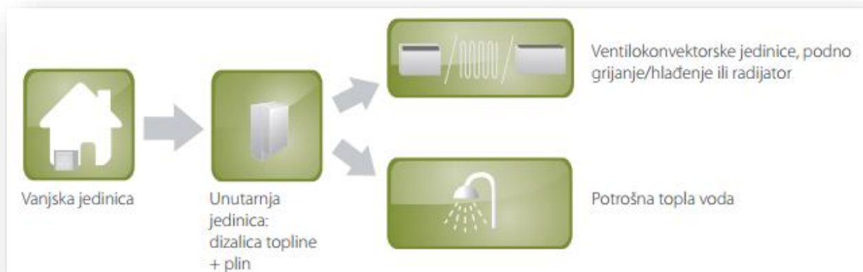
Slika 2.9 Shema rada hibridne dizalice topline, [2].
