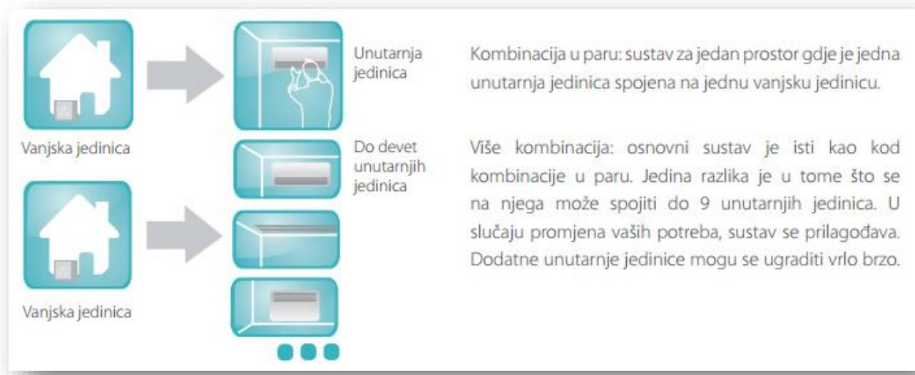
**Slika 2.7 Shema rada dizalice topline zrak-zrak, [2].**
