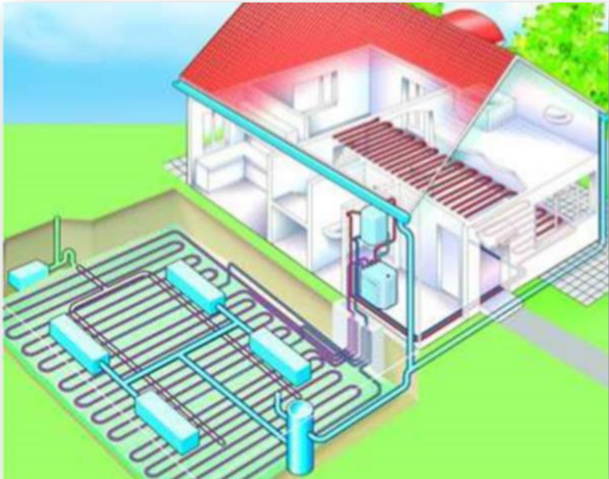
Slika 2.5 Dizalica topline spojena na sustav podnog grijanja, [3, 4].
