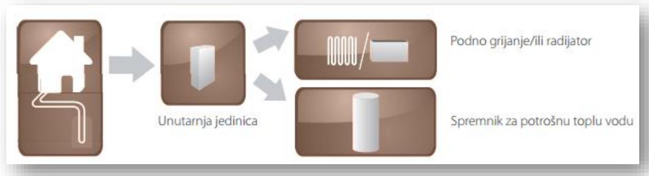
**Slika 2.8 Shema rada geotermalne dizalice topline tlo-voda, [2].**
