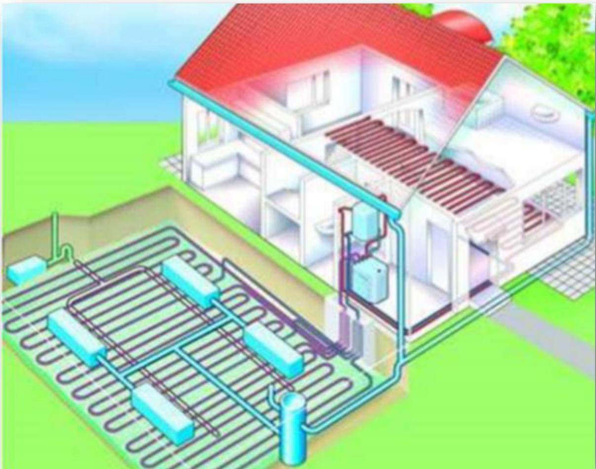
Slika 2.5 Dizalica topline spojena na sustav podnog grijanja, [3, 4].
