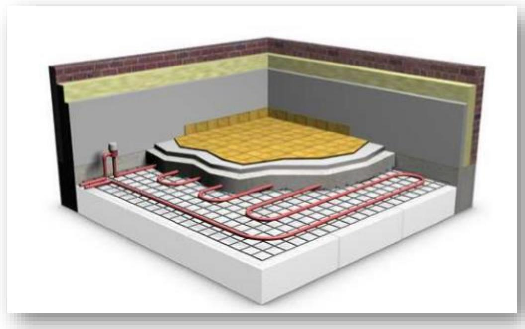
**Slika 2.12 Presjek sustava podnoga grijanja, [3, 4].**
