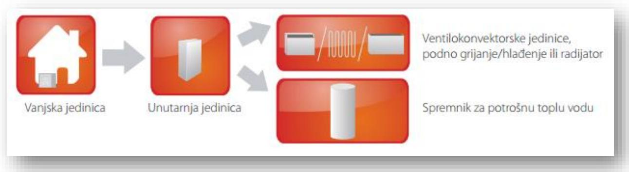
**Slika 2.6 Shema rada dizalice topline zrak-voda, [2].**
