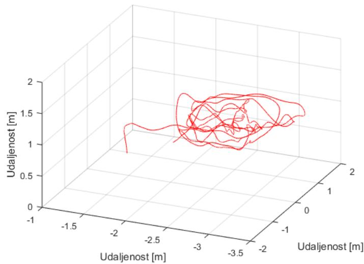
**Slika 6.8** Prikaz trajektorije letjelice snimljene Vicon sustavom.
