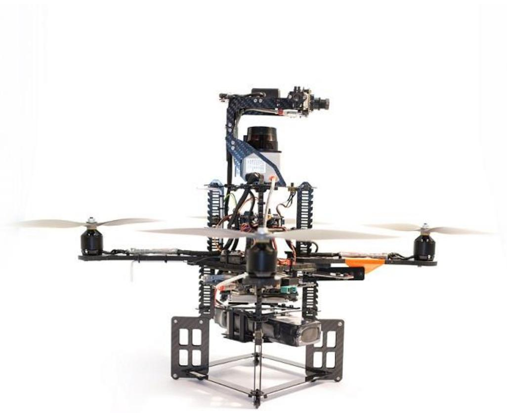
**Slika 6.1** AscTec<sup>TM</sup> Pelican UAV mjerna platforma [22].
