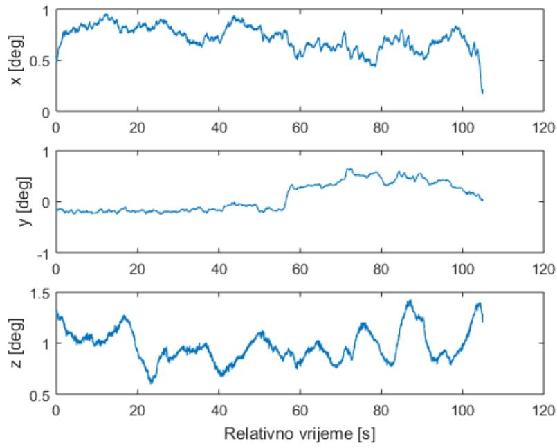
**Slika 6.4** Mjerenja magnetometrom u tri osi.
