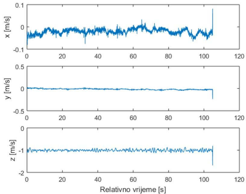
**Slika 6.3** - Mjerenja akcelerometrom u tri osi.
