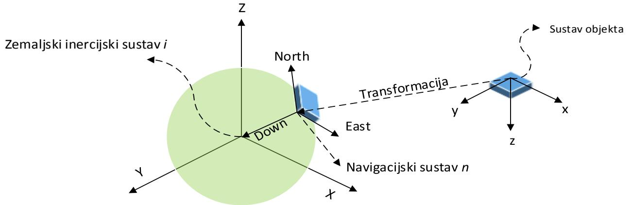
**Slika 2.2** Prikaz referentnoga sustava (lijevo) i sustava objekta (desno).
