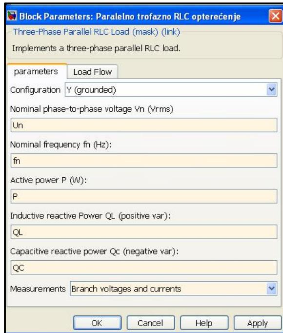
**Slika 4.29.** Parametriranje simulacijskog bloka parametri nadomjesnog trofaznog opterećenja
