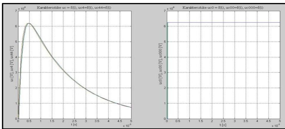
**Slika 2.26.** Usporedba generiranog sklopnnog prenapona  $u_c(t)$  s referentnom funkcijom  $u_0(t)$  uz uvjet različitih trenutaka sinkrone prorade iskrišta i 50 % tjemene vrijednosti prenapona  $U_m$
