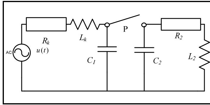
**Slika 2.43.** Nadomjesna shema energetskog transformatora opterećenog prigušnicom
