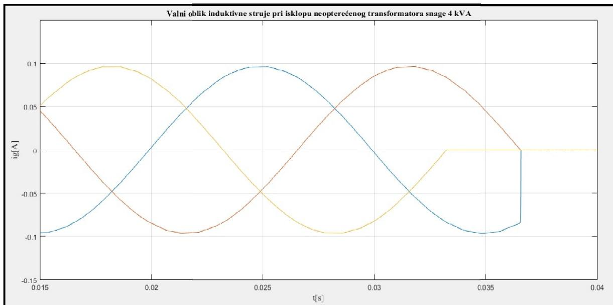
**Slika 9.11.** Oblik induktivne struje pri isklopu neopterećenog transformatora snage 4 kVA
