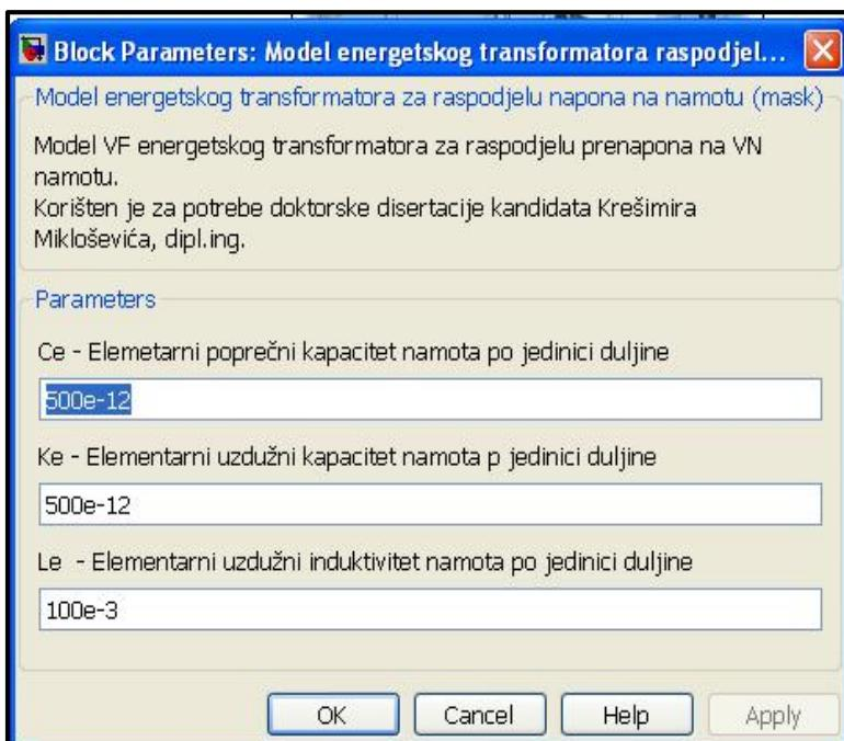
**Slika 4.8.** Ulagani parametri u pojednostavljeni simulacijski model distributivnog transformatora za raspodjelu sklopnog prenapona
