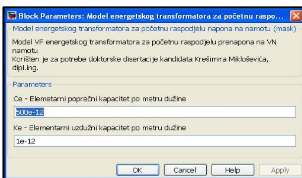
**Slika 6.3.** Ulagani parametri u pojednostavljeni simulacijski model distributivnog transformatora za početnu raspodjelu sklopnog prenapona
