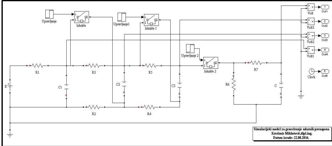
**Slika 2.12.** Simulacijski model za generiranje udarnih prenapona
