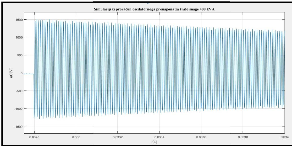
**Slika 6.35.** Skloplni prenapon faze L1 za transformator snage 400 kVA
