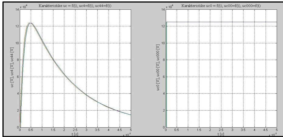
**Slika 2.18.** Usporedba generiranog sklopnog prenapona  $u_c(t)$  s referentnom funkcijom  $u_0(t)$  uz uvjet različitih trenutaka sinkrone prorade iskrišta i maksimalne tjemene vrijednosti prenapona  $U_m$
