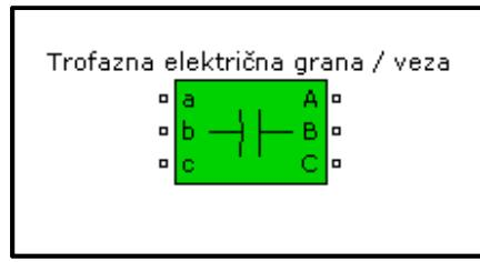
**Slika 4.26.** Blok simulacijskog modela trofazne električne grane
