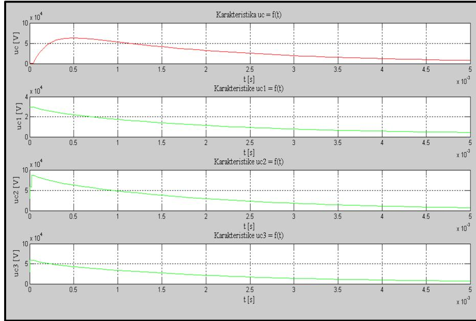
**Slika 2.31.** Karakteristični vremenski odzivi prvog  $u_{c1}(t)$ , drugog  $u_{c2}(t)$ , trećeg  $u_{c3}(t)$  i posljednjeg  $u_c(t)$  stupnja sinkronog generatora uz uvjet asinkronog trenutka prorade iskrišta i 50 % tjemene vrijednosti prenapona  $U_m$
