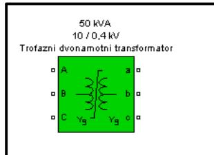
**Slika 4.23.** Blok simulacijskog modela dvonamotnog trofaznog transformatora
