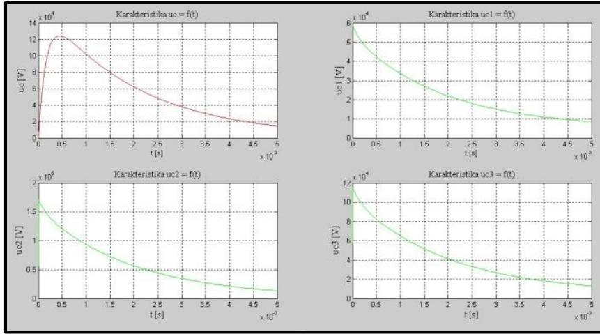
**Slika 2.15.** Karakteristični vremenski odzivi prvog  $u_{c1}(t)$ , drugog  $u_{c2}(t)$ , trećeg  $u_{c3}(t)$  i posljednjeg  $u_c(t)$  stupnja sklopnog generatora uz uvjet jednakog trenutka prorade iskrišta i maksimalne tjemene vrijednosti prenapona  $U_m$
