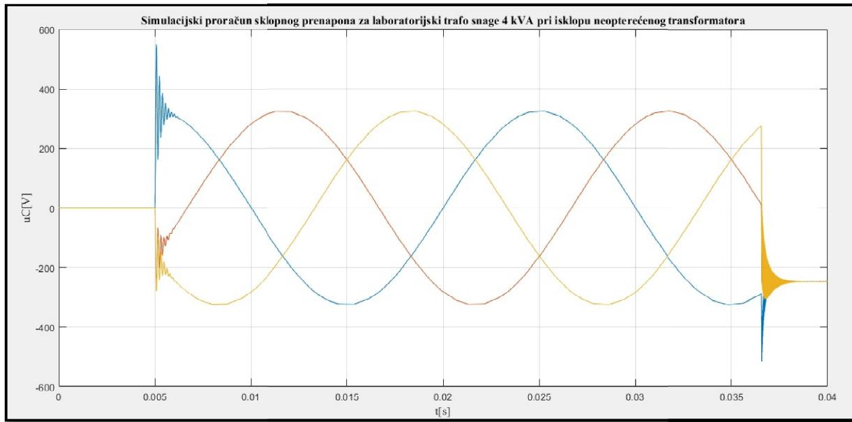
**Slika 9.10.** Simulacijski odziv sklopnog prenapona za laboratorijski transformator snage 4 kVA pri isklopu malih induktivnih struja
