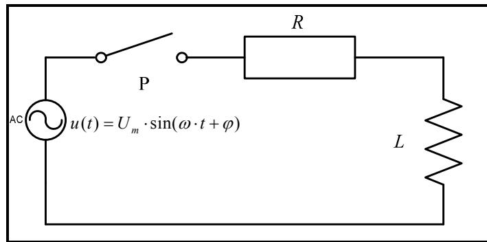
Slika 2.39. Uklop idealnog prekidača na  $RL$  krug
