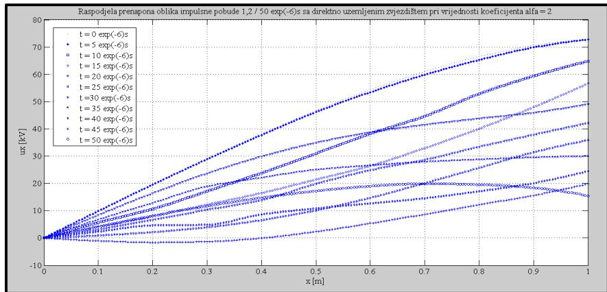
**Slika 6.22.** Raspodjela prenapona oblika impulsne pobude u direktno uzemljenom namotu u rasponu od početne raspodjele ( $t = 0 \mu\text{s}$ ) do  $t = 50 \mu\text{s}$  za  $\alpha = 2$
