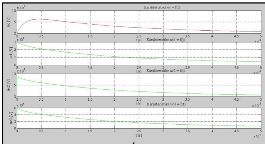
**Slika 2.24.** Karakteristični vremenski odzivi prvog  $u_{c1}(t)$ , drugog  $u_{c2}(t)$ , trećeg  $u_{c3}(t)$  i posljednjeg  $u_c(t)$  stupnja sinkronog generatora uz uvjet sinkronog trenutka prorade iskrišta i 50 % tjemene vrijednosti prenapona  $U_m$
