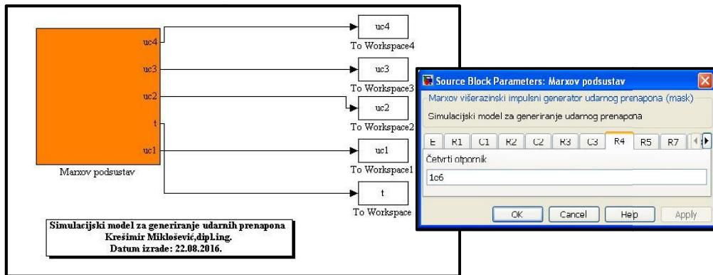
**Slika 2.13.** Simulacijski podsustav za generiranje udarnih sklopnih prenapona
