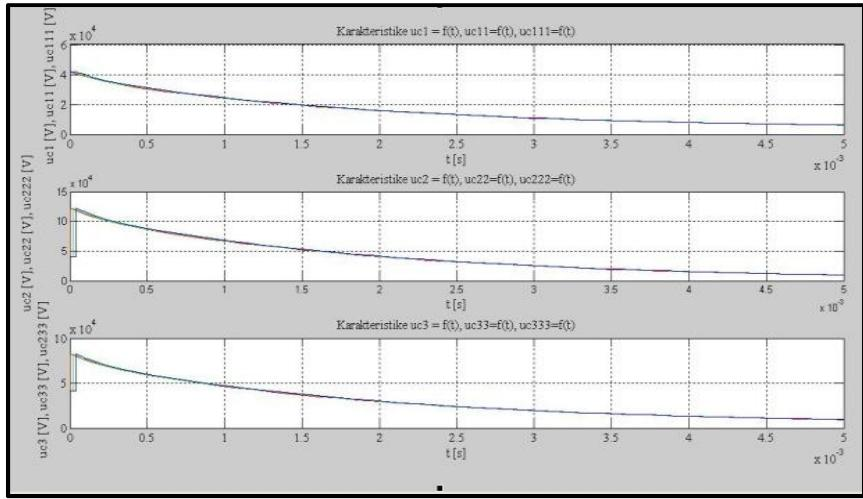
**Slika 2.21.** Usporedba karakterističnih vremenskih odziva prvog  $u_{c1}(t)$ , drugog  $u_{c2}(t)$ , trećeg  $u_{c3}(t)$  stupnja sklopnog generatora uz uvjet različitih trenutaka prorade iskrišta i 75 % tjemene vrijednosti prenapona  $U_m$
