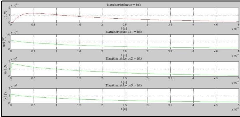
**Slika 2.27.** Karakteristični vremenski odzivi prvog  $u_{c1}(t)$ , drugog  $u_{c2}(t)$ , trećeg  $u_{c3}(t)$  i posljednjeg  $u_c(t)$  stupnja sinkronog generatora uz uvjet asinkronog trenutka prorade iskrišta i 100 % tjemene vrijednosti prenapona  $U_m$
