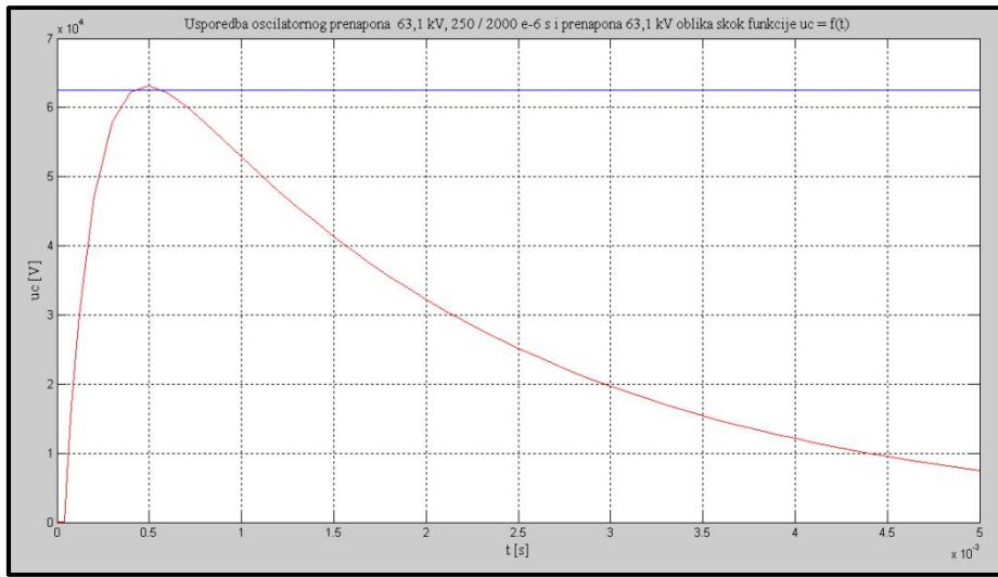
**Slika 2.32.** Usporedba sklopnog prenapona  $u_c(t)$  63,1 kV, 250 / 2000  $\mu\text{s}$  i prenapona  $u_0(t)$  63,1 kV oblika skokovite funkcije
