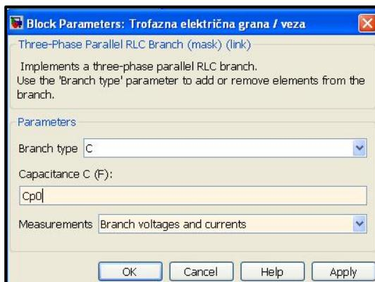
**Slika 4.27.** Parametriranje simulacijskog bloka paralelne trofazne električne veze
