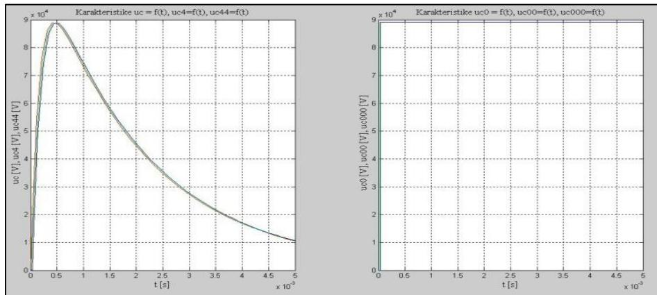
**Slika 2.22.** Usporedba generiranog sklopnog prenapona  $u_c(t)$  s referentnom funkcijom  $u_0(t)$  uz uvjet različitih trenutaka sinkrone prorade iskrišta i 75 % tjemene vrijednosti prenapona  $U_m$ .
