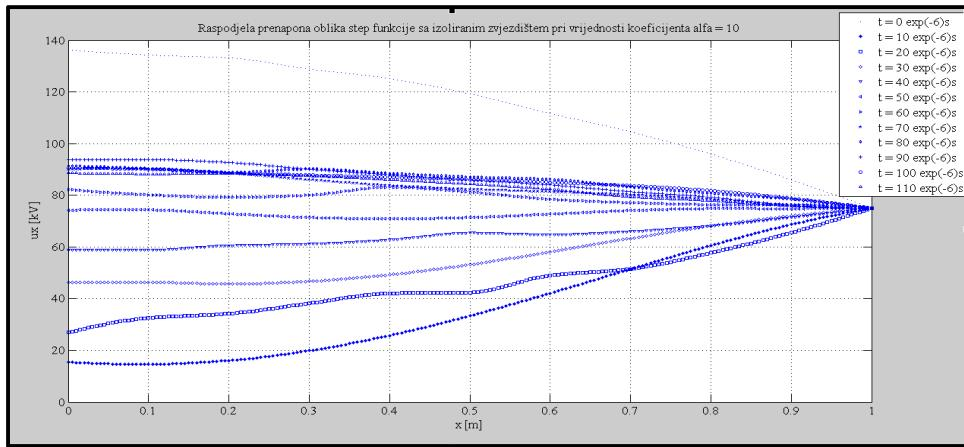
**Slika 6.21.** Raspodjela prenapona oblika step pobude u izoliranom namotu u rasponu od početne raspodjele ( $t = 0 \mu\text{s}$ ) do  $t = 110 \mu\text{s}$  za  $\alpha = 10$
