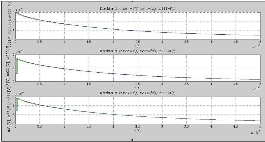
**Slika 2.25.** Karakteristični vremenski odzivi prvog  $u_{c1}(t)$ , drugog  $u_{c2}(t)$  i trećeg  $u_{c3}(t)$  stupnja sinkronog generatora uz uvjet sinkronog trenutka prorade iskrišta i 50 % tjemene vrijednosti prenapona  $U_m$
