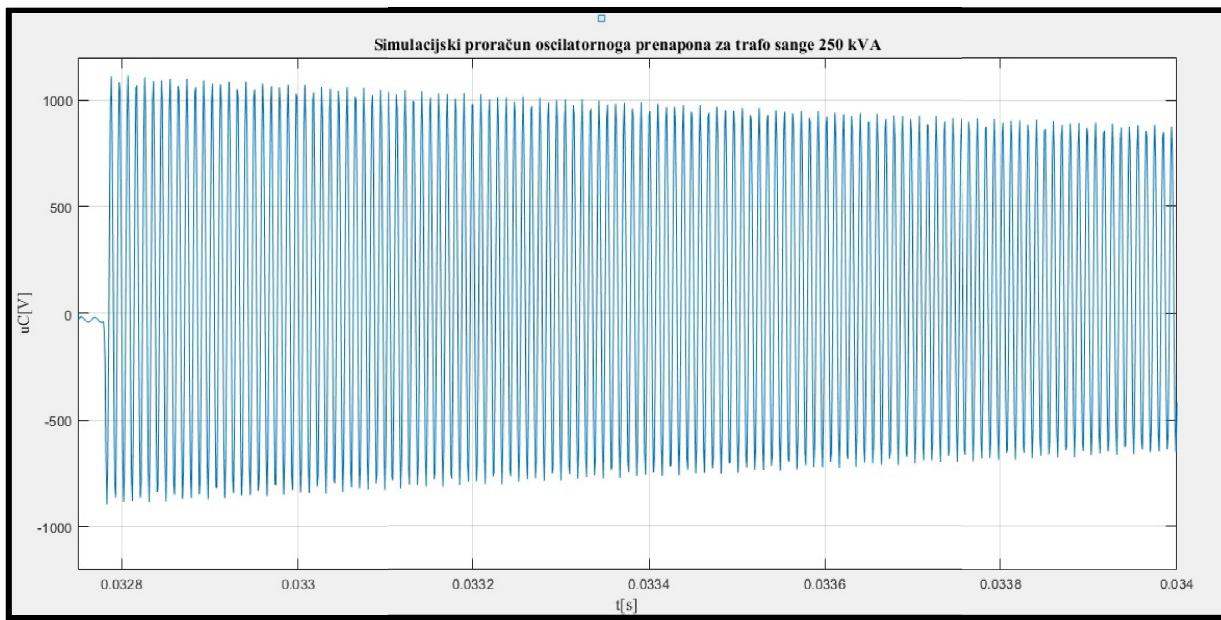
**Slika 6.34.** Skloplni prenapon faze L1 za transformator snage 250 kVA
