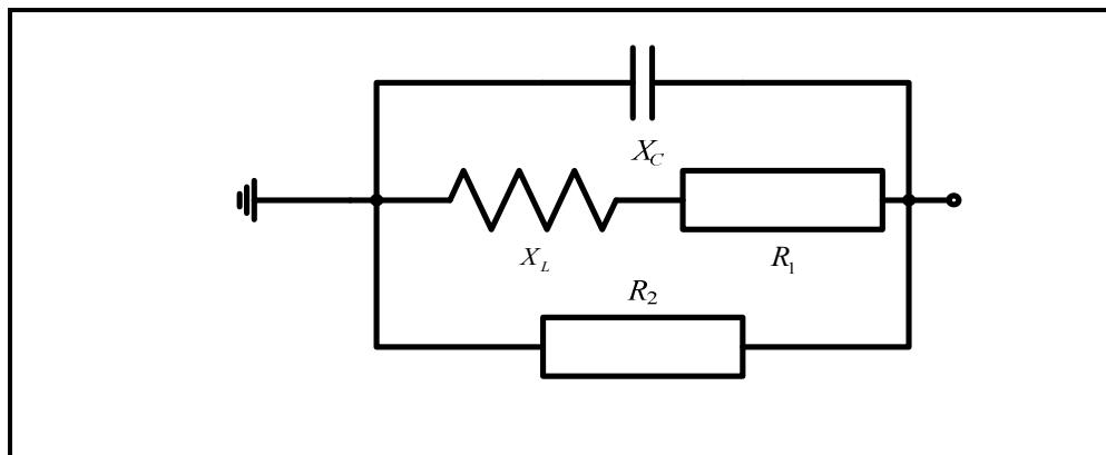
**Slika 3.5.** Nadomjesni model prigušnice za visokofrekvenčne sklopne događaje
