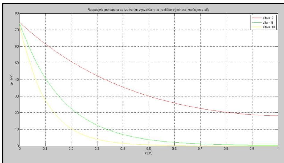
**Slika 6.8.** Početna raspodjela napona na izoliranom namotu za različite vrijednosti koeficijenta  $\alpha$
