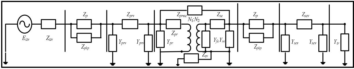
**Slika 4.10.** Jednofazna ekvivalentna mreža za istraživane utjecaja konfiguracije primarnih i sekundarnih krugova transformatora na karakteristiku sklopog prenapona
