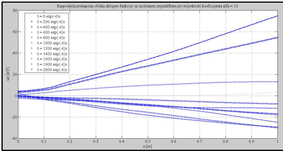
**Slika 6.29.** Raspodjela prenapona oblika sklopne pobude u izoliranom namotu u rasponu od početne raspodjele ( $t = 0 \mu s$ ) do  $t = 110 \mu s$  za  $\alpha = 10$
