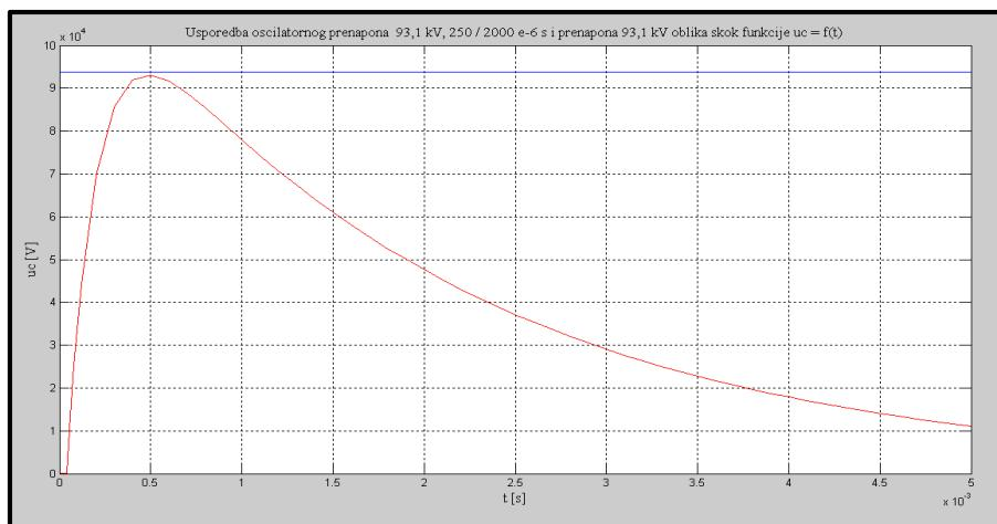
**Slika 2.30.** Usporedba sklopnog prenapona  $u_c(t)$  93,1 kV, 250 / 2000 μs i prenapona  $u_0(t)$  93,1 kV oblika skokovite funkcije
