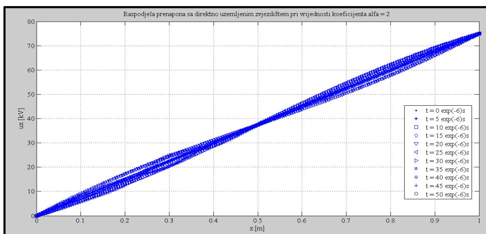
**Slika 6.18.** Raspodjela prenapona oblika step pobude u direktno uzemljenom namotu u rasponu od početne raspodjеле ( $t = 0 \mu\text{s}$ ) do  $t = 50 \mu\text{s}$  za  $\alpha = 2$
