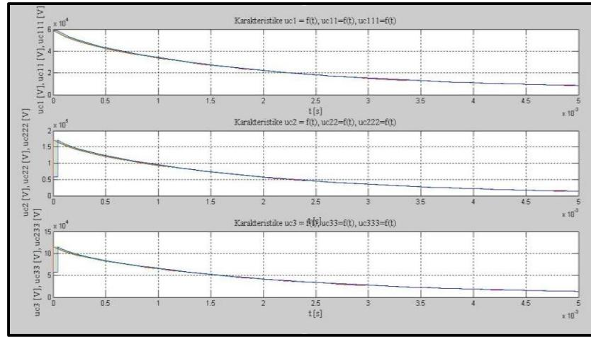
**Slika 2.17.** Usporedba karakterističnih vremenskih odziva prvog  $u_{c1}(t)$ , drugog  $u_{c2}(t)$ , trećeg  $u_{c3}(t)$  stupnja sklopnog generatora uz uvjet različitih trenutaka sinkrone prorade iskrišta i maksimalne tjemene vrijednosti prenapona  $U_m$
