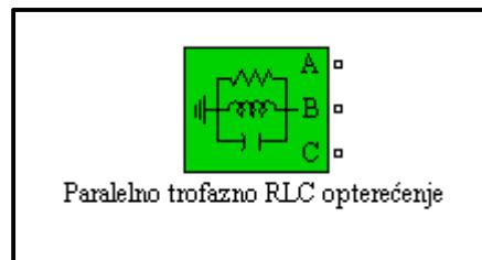
Slika 4.28. Blok simulacijskog modela nadomjesnog trofaznog opterećenja
