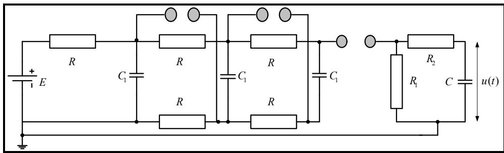
**Slika 2.11.** Marxov višerazinski impulsni generator udarnog napona
