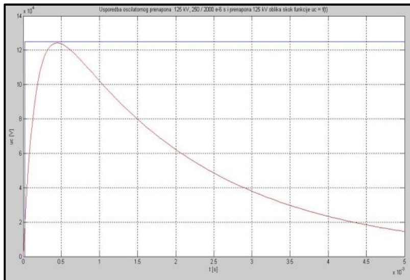
Slika 2.16. Usporedba sklopnog prenapona u_c(t) 125 kV, 250 / 2000 \mu\text{s} i prenapona u_0(t) 125 kV oblika skokovite funkcije
