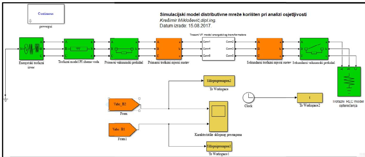
**Slika 5.6.** Dizajn simulacijskog modela testne distributivne mreže SmtdmGUI2.fig.
