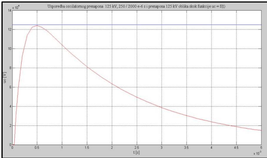
**Slika 2.28.** Usporedba sklopnog prenapona  $u_c(t)$  125 kV, 250 / 2000 μs i prenapona  $u_0(t)$  125 kV oblika skokovite funkcije
