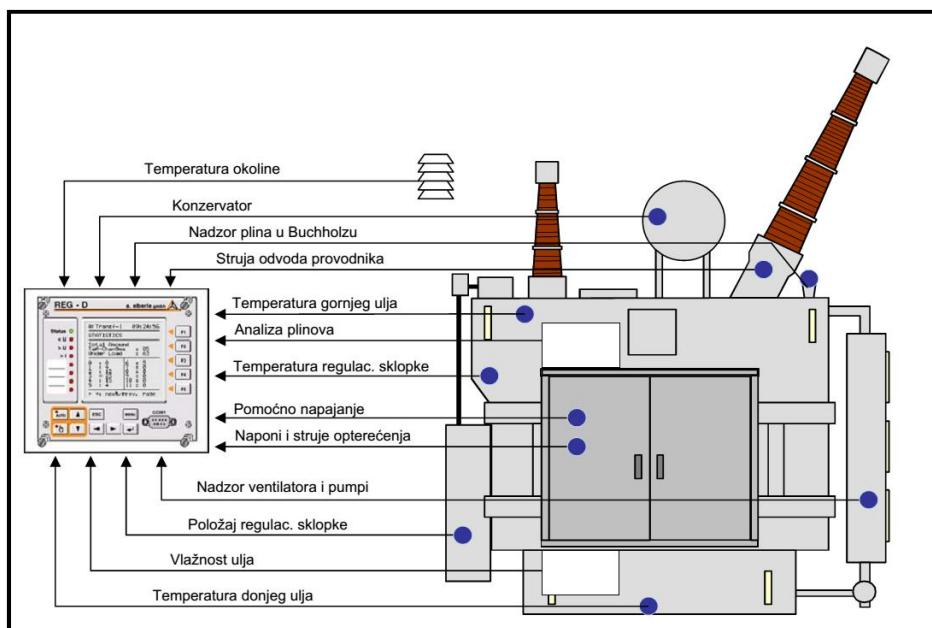
**Slika 8.1.** Integrirani dijagnostički i monitoring podsustavi energetskog transformatora [75]
