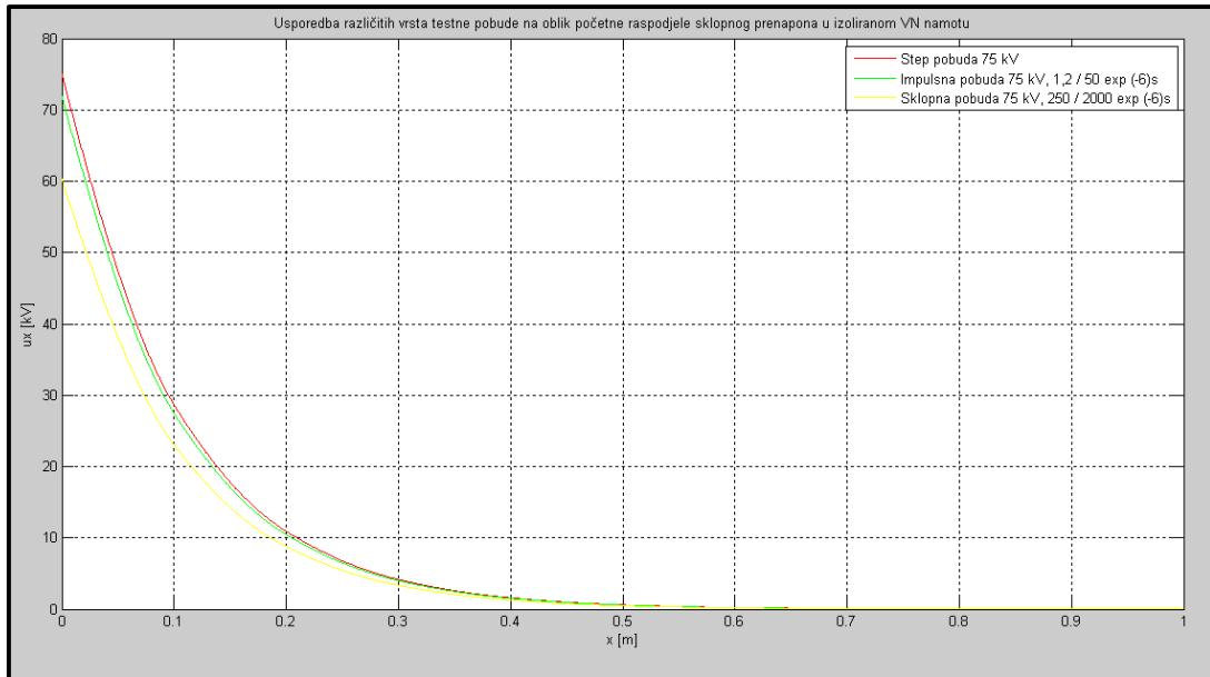
**Slika 6.12.** Usporedba različitih vrsta testne pobude na oblik početne raspodjele sklopog prenapona u izoliranom namotu uz  $\alpha = 10$
