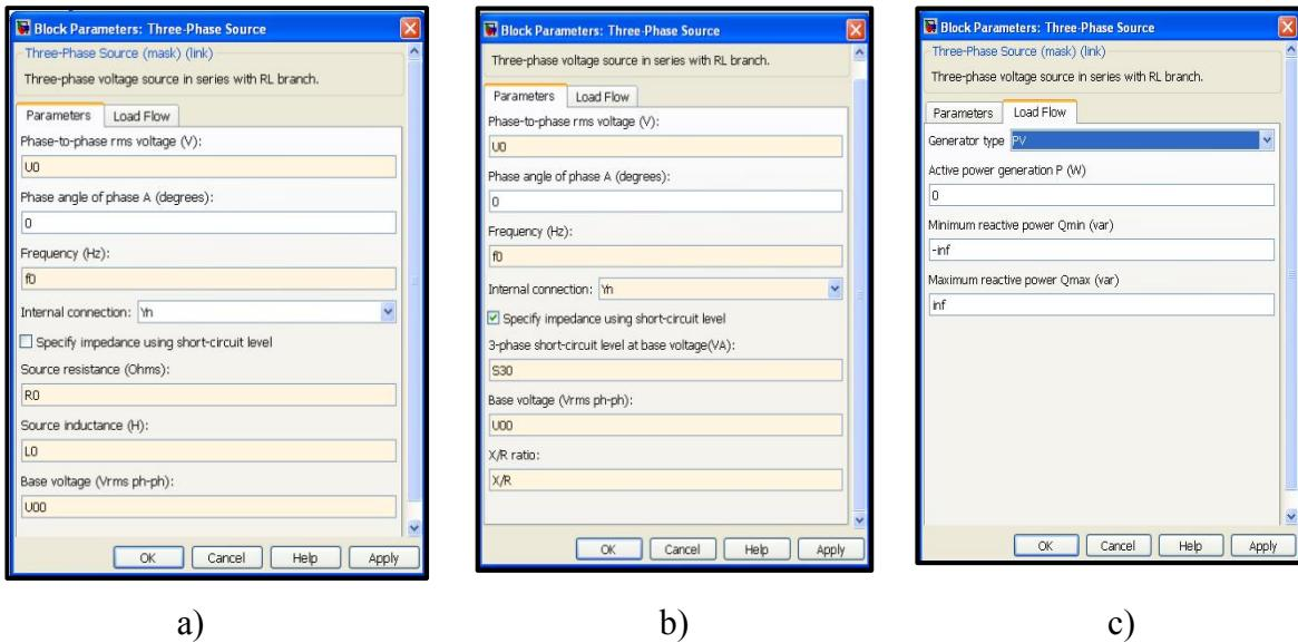
**Slika 4.17.** Ulazni parametri nadomjesnog izvora, a) izravno parametrisanje, b) neizravno parametrisanje, c) parametrisanje načina rada trofaznog izvora
