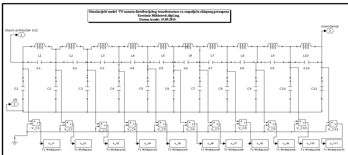
**Slika 4.6.** Simulacijsko modeliranje pojednostavljenje nadomjesne sheme namota transformatora
