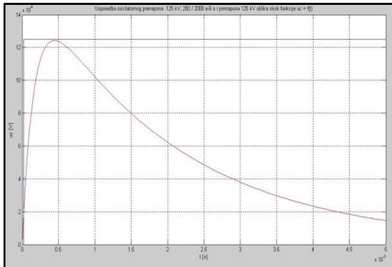
**Slika 2.16.** Usporedba sklopnog prenapona  $u_c(t)$  125 kV, 250 / 2000 μs i prenapona  $u_0(t)$  125 kV oblika skokovite funkcije
