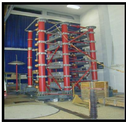
**Slika 2.7.** Izvedba generatora za ispitivanje udarnim naponima [42]
