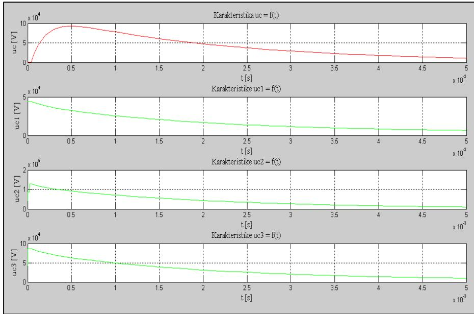
**Slika 2.29.** Karakteristični vremenski odzivi prvog  $u_{c1}(t)$ , drugog  $u_{c2}(t)$ , trećeg  $u_{c3}(t)$  i posljednjeg  $u_c(t)$  stupnja sklopnog generatora uz uvjet asinkronog trenutka prorade iskrišta i 75 % tjemene vrijednosti prenapona  $U_m$
