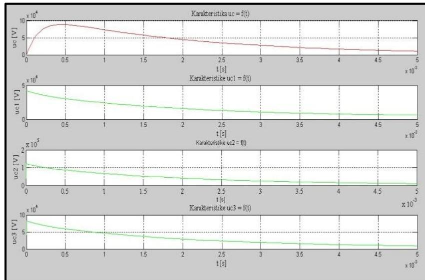
**Slika 2.20.** Karakteristični vremenski odzivi prvog  $u_{c1}(t)$ , drugog  $u_{c2}(t)$ , trećeg  $u_{c3}(t)$  i posljednjeg  $u_c(t)$  stupnja sklopnog generatora uz uvjet sinkronog trenutka prorade iskrišta i 75 % tjemene vrijednosti prenapona  $U_m$
