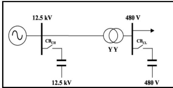
**Slika 2.35.** Sustav za simulaciju promjene napona tijekom uklopa kondenzatora [11]
