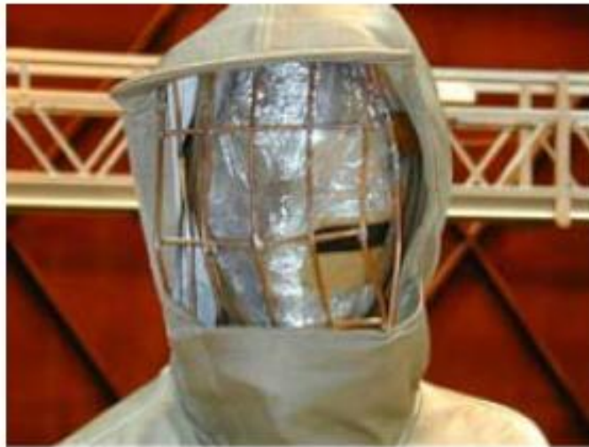
Sl. 4.2. Vodljivo odijelo s mrežom preko lica (veći otvori) [17].
