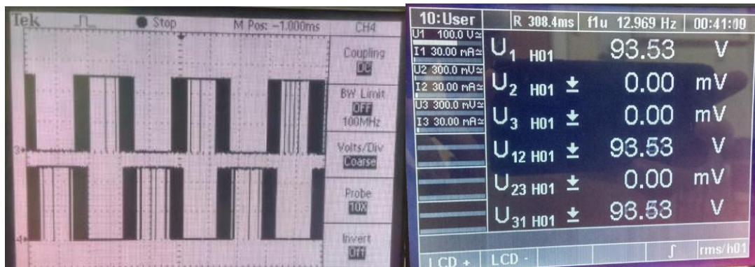
Slika 5.9. – a) vođenje para MOSFET-a, b) Spektralni analizator nije uspio odrediti osnovni harmonik
