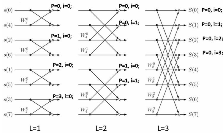
Sl. 4.11: Prikaz stanja  $P$  i brojača u ovisnosti o stupnjevima množenja  $L$ .
