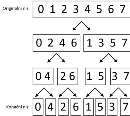
Sl. 2.2: Rastavljanje ulaznog signala u DIT postupku.
