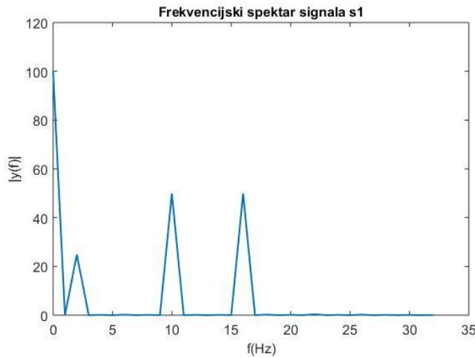
Sl. 5.7: Prikaz frekvencijskog spektra testnog signala s1.
