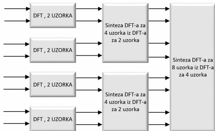
Sl. 2.6: Blok prikaz DIT izračuna za 8 uzoraka.
