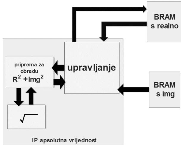
Sl. 4.12: Pojednostavljeni blok-prikaz IP-a za izračun absolutne vrijednosti.
