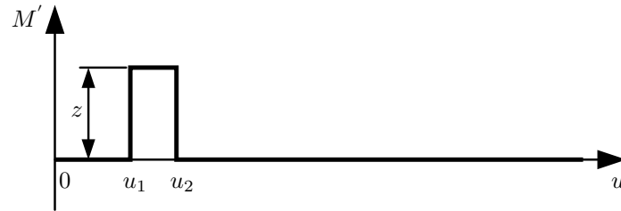
Slika 5.8: Primjer pravokutnog impulsa.
