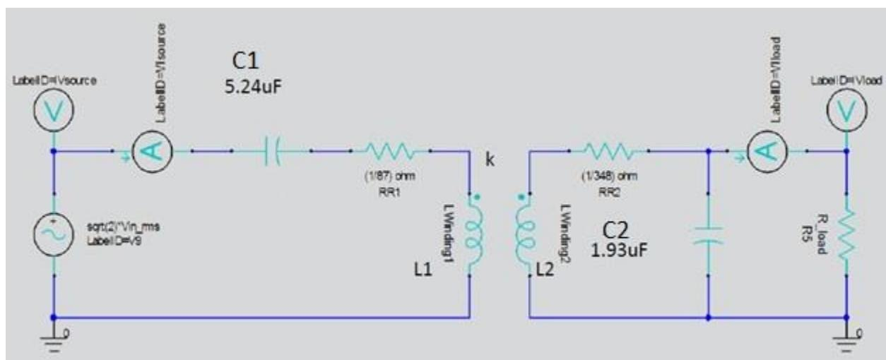
**Slika 2.5.** Shema zračnog transformatora u ANSYS Maxwell programu
