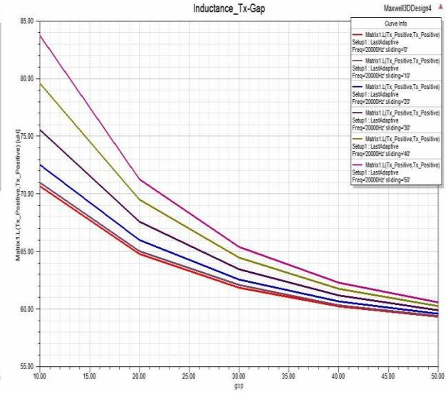
Slika 5.9. Induktivitet Tx (Fe ploče)
