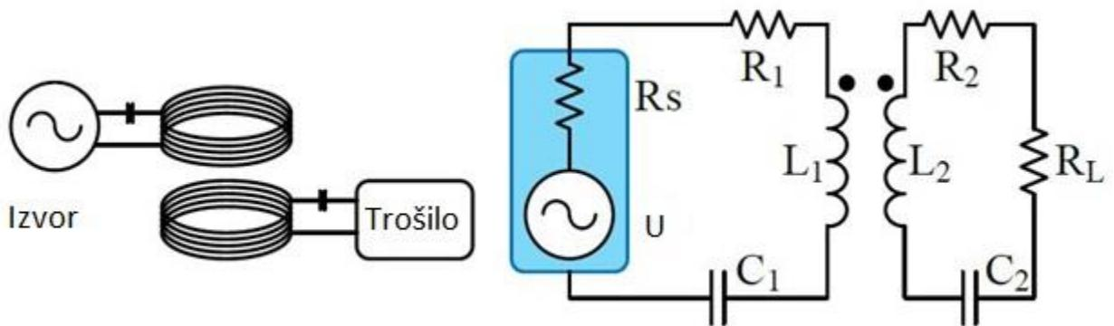
**Slika 2.2.** Rezonantni induktivni prijenos energije bez feromagnetske jezgre
