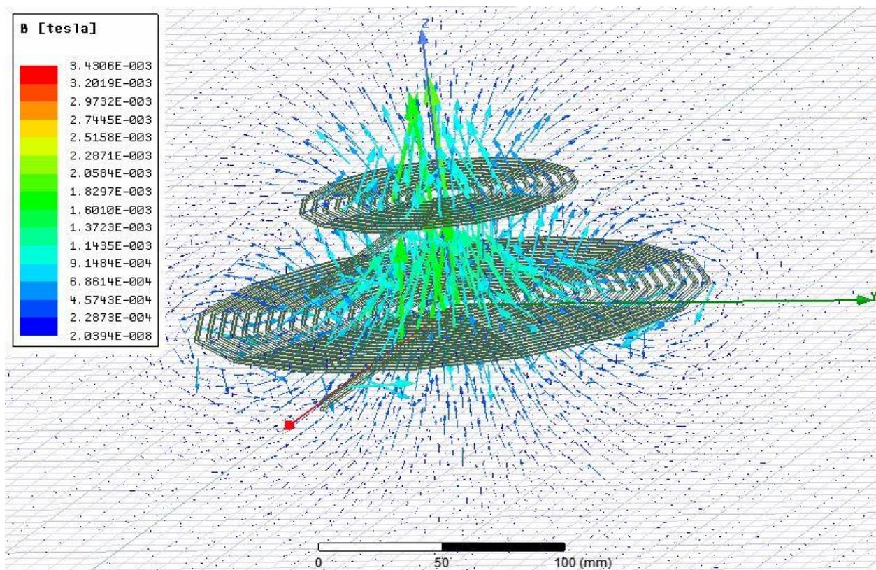
Slika 5.29. Vektori magnetske indukcije uz zračni raspor 50 mm
