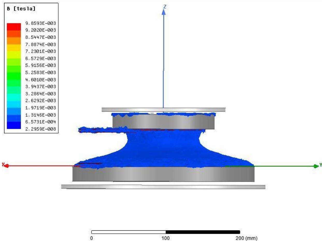
Slika 5.33. Prikaz magnetske indukcije dopunjeno modela zračni raspor 50 mm
