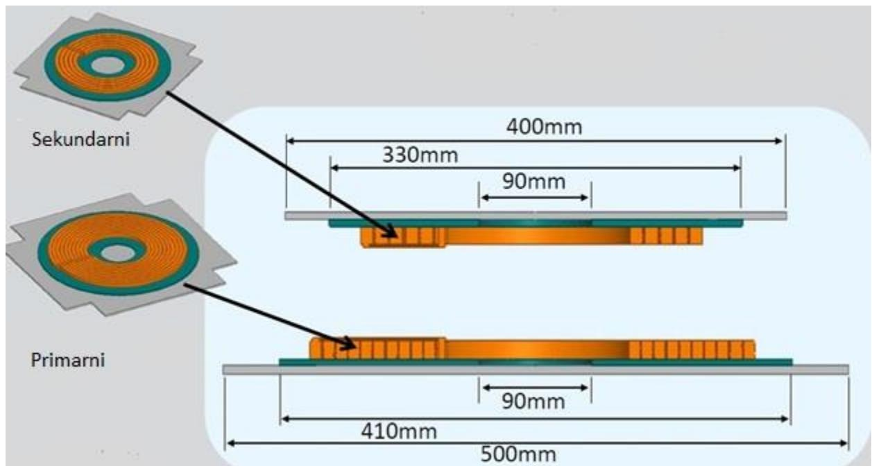
**Slika 2.9.** Model zračnog transformatora
