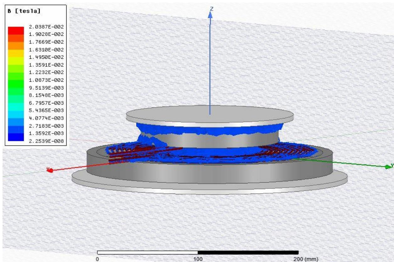
Slika 5.32. Prikaz magnetske indukcije dopunjjenog modela zračni raspor 10 mm
