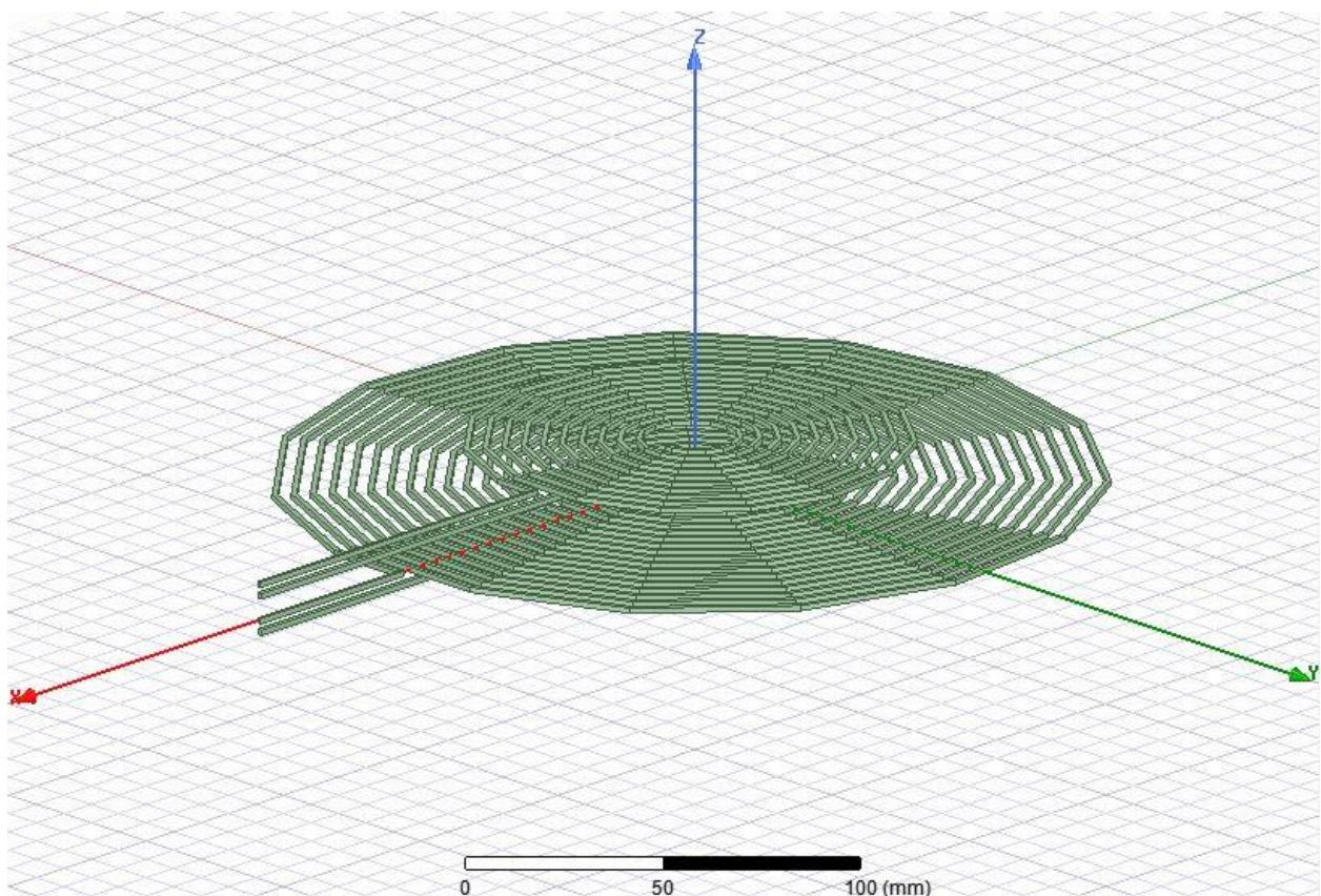
**Slika 5.24.** Prikaz namota uz zračni raspor 10 mm
