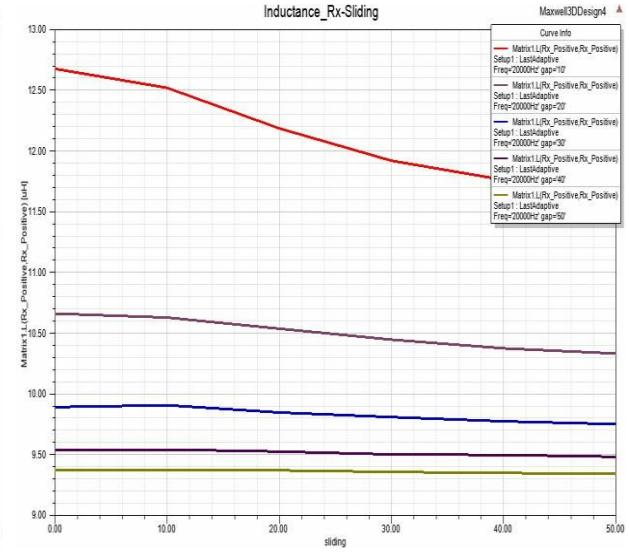
Slika 5.15. Induktivitet Rx (Fe ploče)
