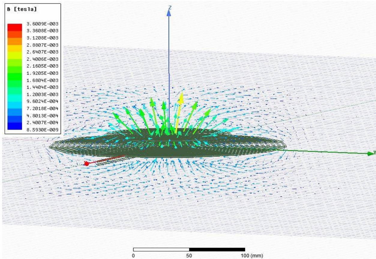
Slika 5.28. Vektori magnetske indukcije uz zračni raspor 10 mm
