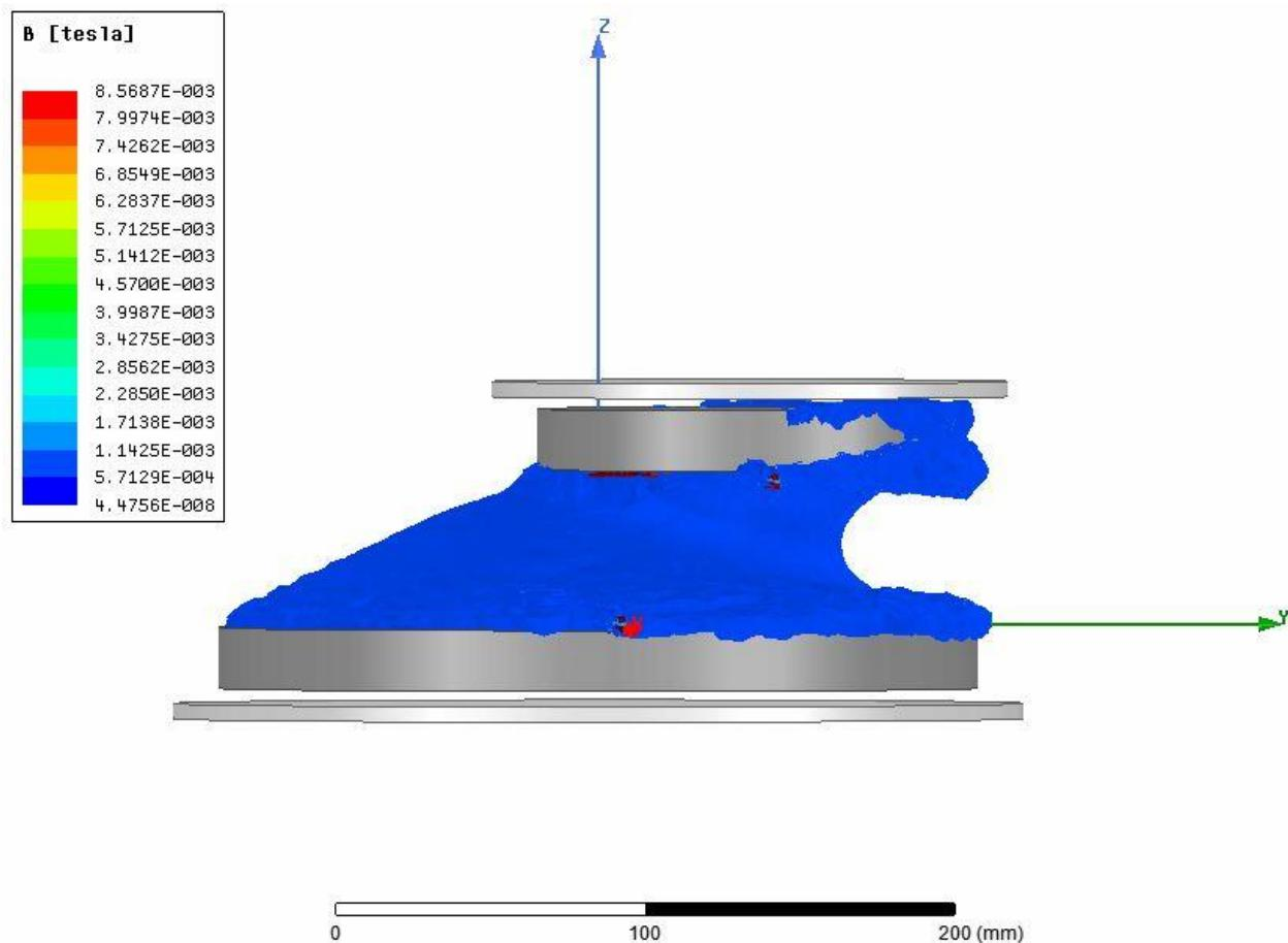
**Slika 5.34.** Prikaz magnetske indukcije dopunjeno modela uz zračni raspor 10 mm i preklapanje 50 mm (od centra)
