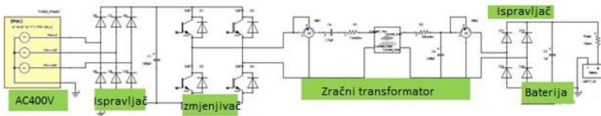
**Slika 2.4.** Shema sustava za bežični prijenos električne energije
