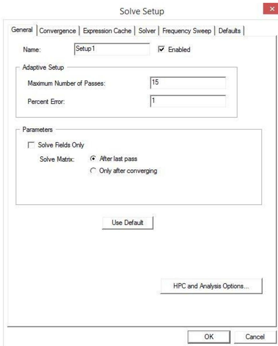
**Slika 4.43.** Parametrisiranje izvođenja simulacije
