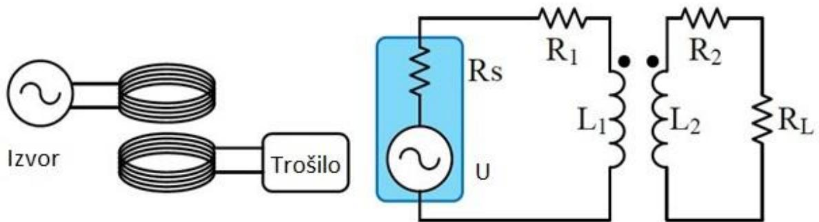
Slika 2.1. Tradicionalni induktivni prijenos energije bez feromagnetske jezgre
