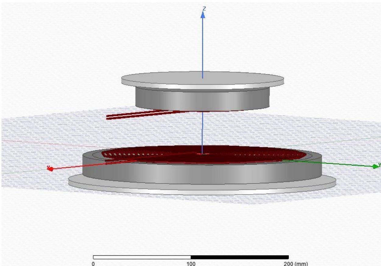
**Slika 2.8.** Model zračnog transformatora u ANSYS Maxwell programu
