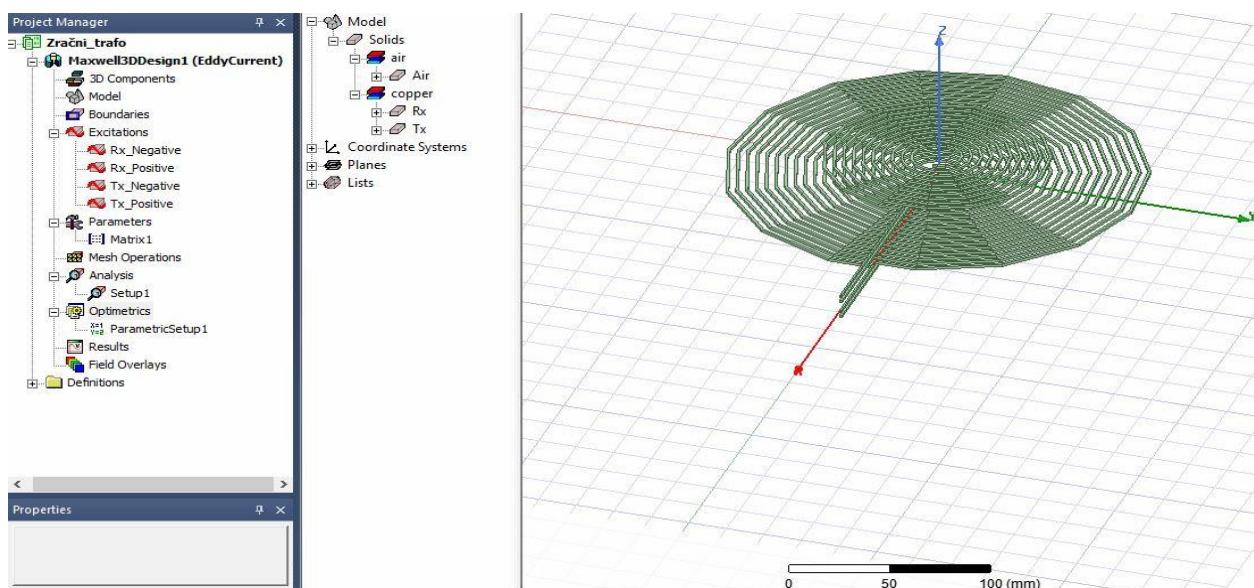
**Slika 4.52.** Gotov osnovni model spreman za provođenje simulacije
