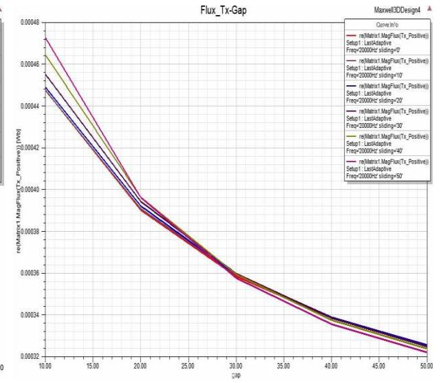
**Slika 5.17.** Magnetski tok Tx (Fe ploče)
