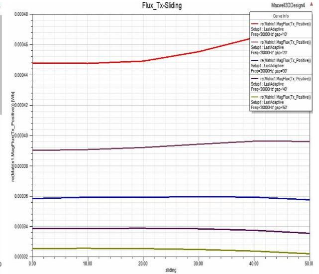
**Slika 5.19.** Magnetski tok Tx (Fe ploče)
